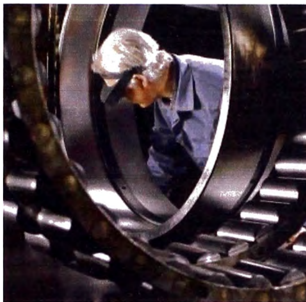
Fig. N°2.2 Evaluación visual de la pista de rodadura de un rodamiento grande.
