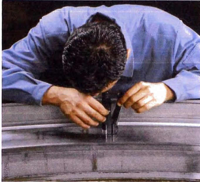
Fig. N°2.3 Examen microscópico de pistas de un rodamiento para una perforadora de túnel.
