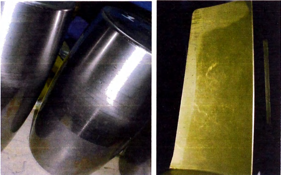
Fig. N°5.10 Marcas de indentaciones suaves en rodillos y desgaste en bordes de alvéolo de jaula debido a deficiente lubricación.
