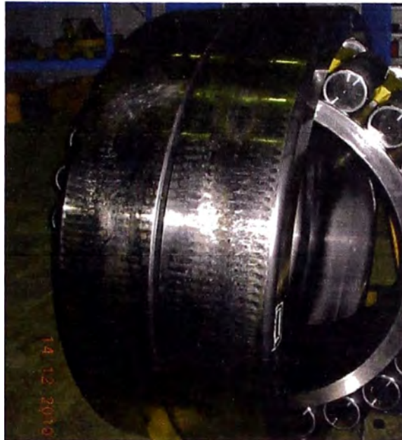
Fig. N°5.26 Corrosión por contacto en diferentes posiciones (giro relativo) sobre asiento de aro exterior debido a ajuste deficiente (desgaste en alojamiento).
