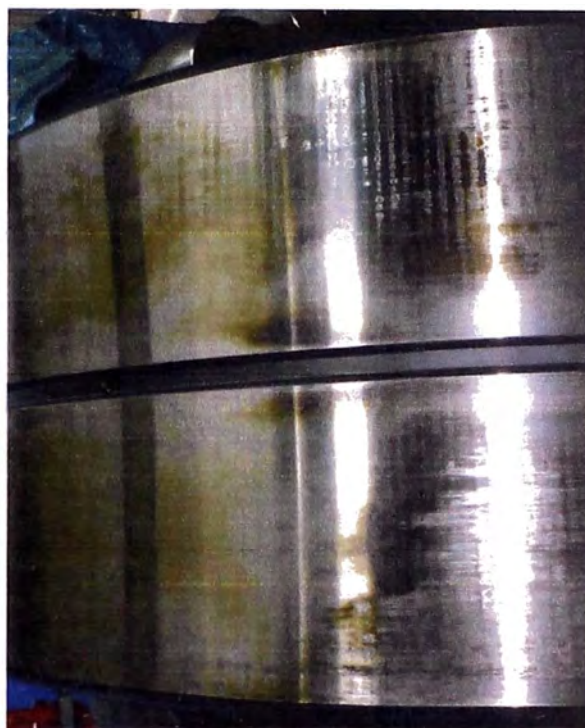
Fig. N°5.40 Corrosión por contacto en asiento de aro exterior debido ajuste deficiente.
