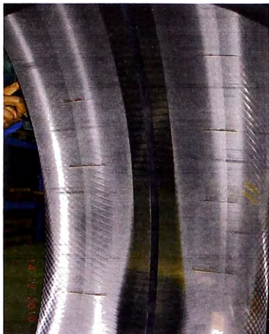
Fig. N° 5.15 Desgaste en zona de carga y corrosión contacto "Standstill" en pista exterior debido a humedad.
