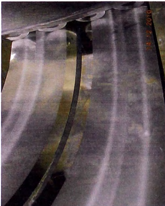
Fig. N°5.27 Huella de desgaste central de rodadura dejado en pista de aro exterior.
