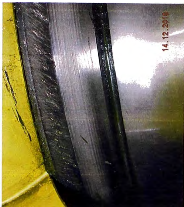
Fig. N°5.29 Desgaste en arista de labio central de pista por carga axial excesiva de rodillo.
