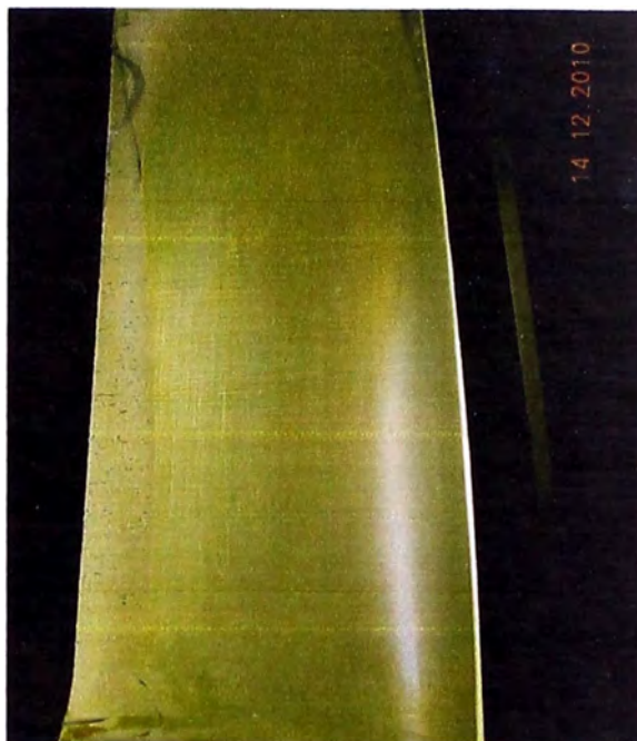
Fig. N°5.30 Desgaste en borde de alvéolos de jaula por lubricación deficiente.
