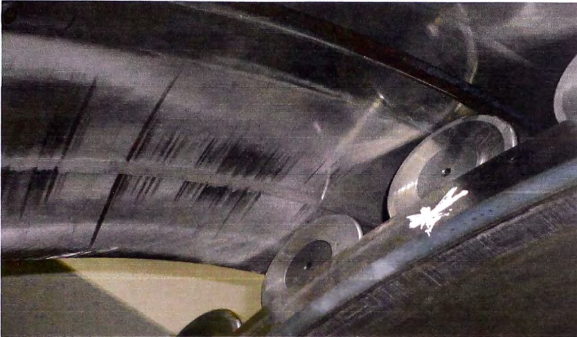
Fig. N°5.74 Marcas de Brinelling y Rayas en pista de aro exterior y rayas en borde de agujero por trabado con eje en desmontaje de rodamiento.
