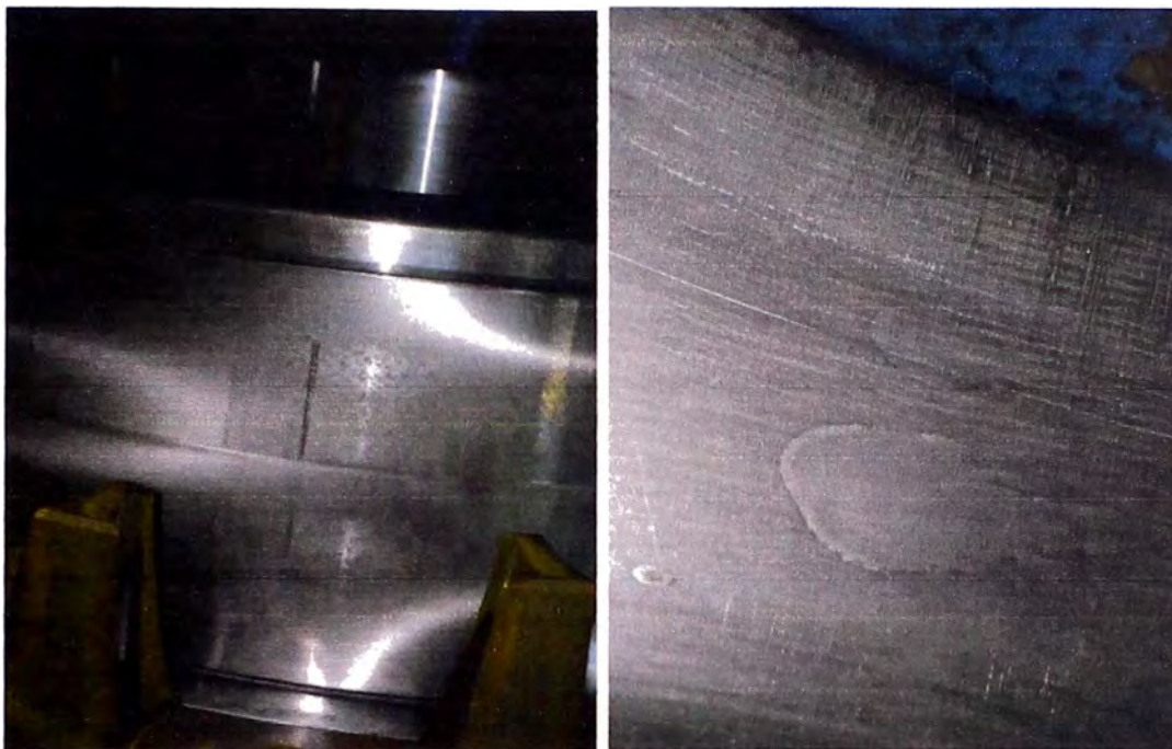
Fig. N°5.64 Desgaste importante con indentación y marca de corrosión "standstill" en pista debido a humedad en parada.
