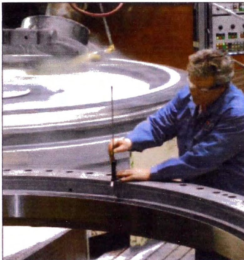
Fig. N°2.8 Proceso de rectificado posterior y control de medidas del aro de un rodamiento de una perforadora de túneles.
