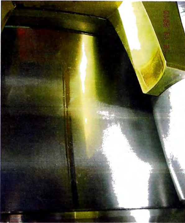
Fig. N°5.36 Indentaciones suaves y superficie brillante con marca de corrosión por contacto "standstill".
