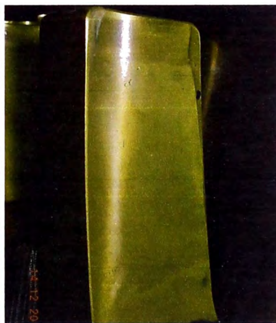
Fig. N°5.17 Desgaste con rayas laterales por exceso de carga axial debido a atascamiento de rodillo en borde de labio central e indentaciones suaves en jaula.
