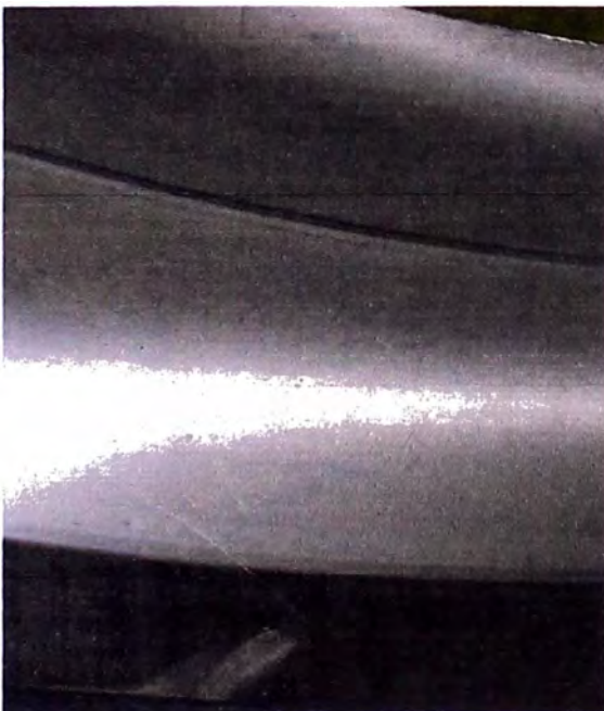
Fig. N°5.8 Desgaste normal y marcas de indentaciones suaves en pista de aro exterior debido a ingreso de contaminantes sólidos por obturación insuficiente.
