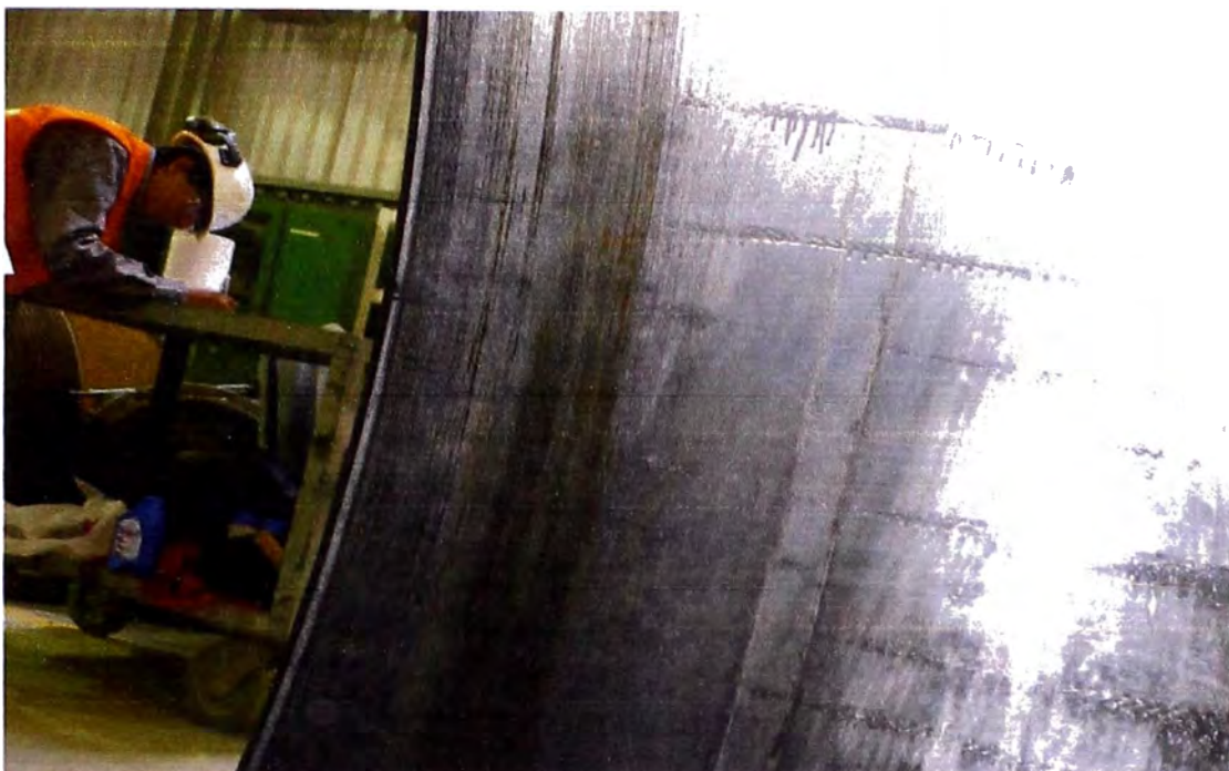
Fig. N°5.81 Marcas circunferenciales de contacto en agujero debido a microgiro del aro interior en eje.
