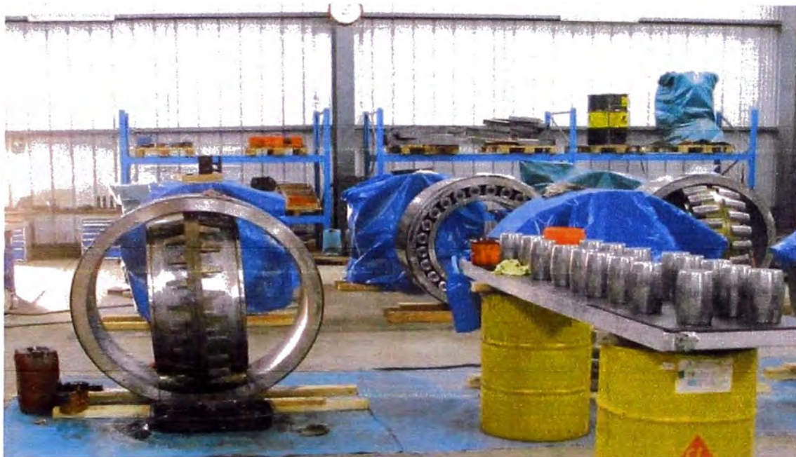
Fig. N°5.5 Desarme parcial del rodamiento para inspección de sus componentes.
