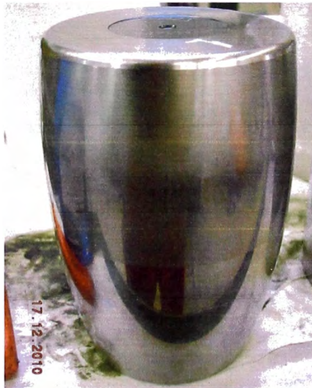
Fig. N°5.78 Indentaciones suaves en rodillo con marca de desgaste por rozamiento con alvéolo de jaula.
