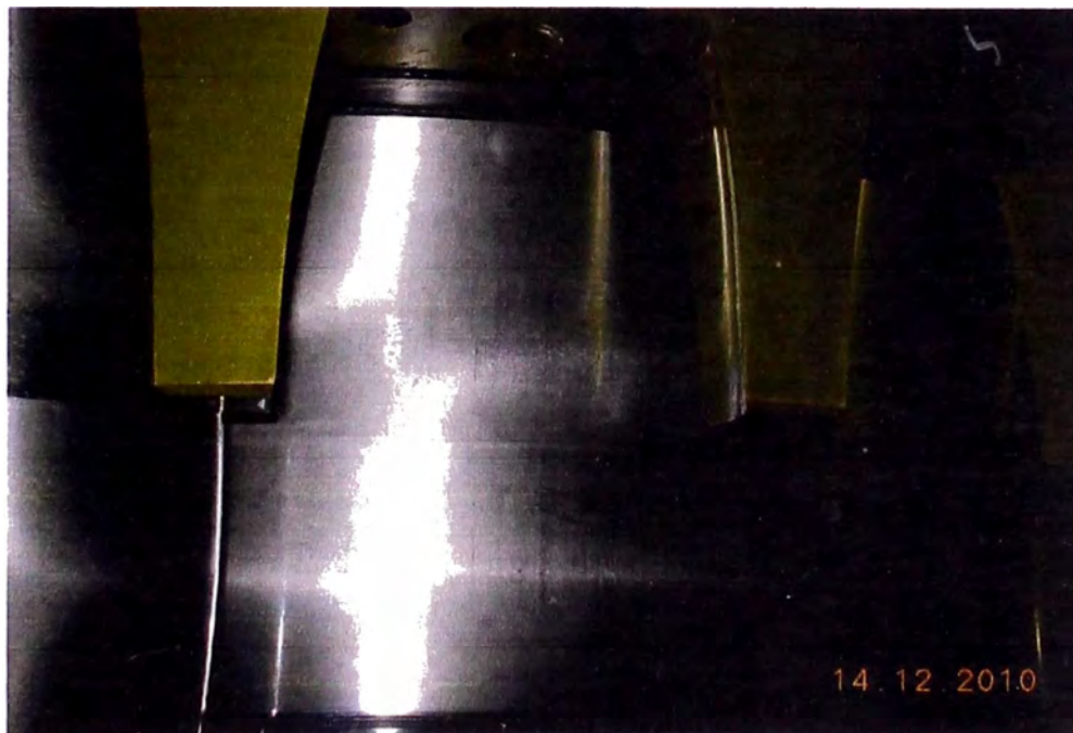
Fig. N°5.31 Huella de desgaste normal con indentaciones suaves en pista de aro interior.
