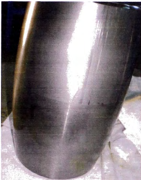
Fig. N°5.43 Desgaste uniforme en rodillo con marca de rozamiento con jaula.
