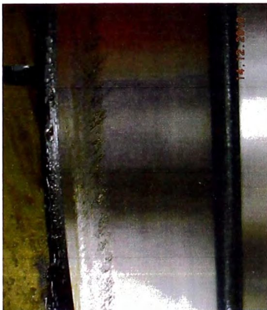
Fig. N°5.17 Desgaste con rayas laterales por exceso de carga axial debido a atascamiento de rodillo en borde de labio central e indentaciones suaves en jaula.
