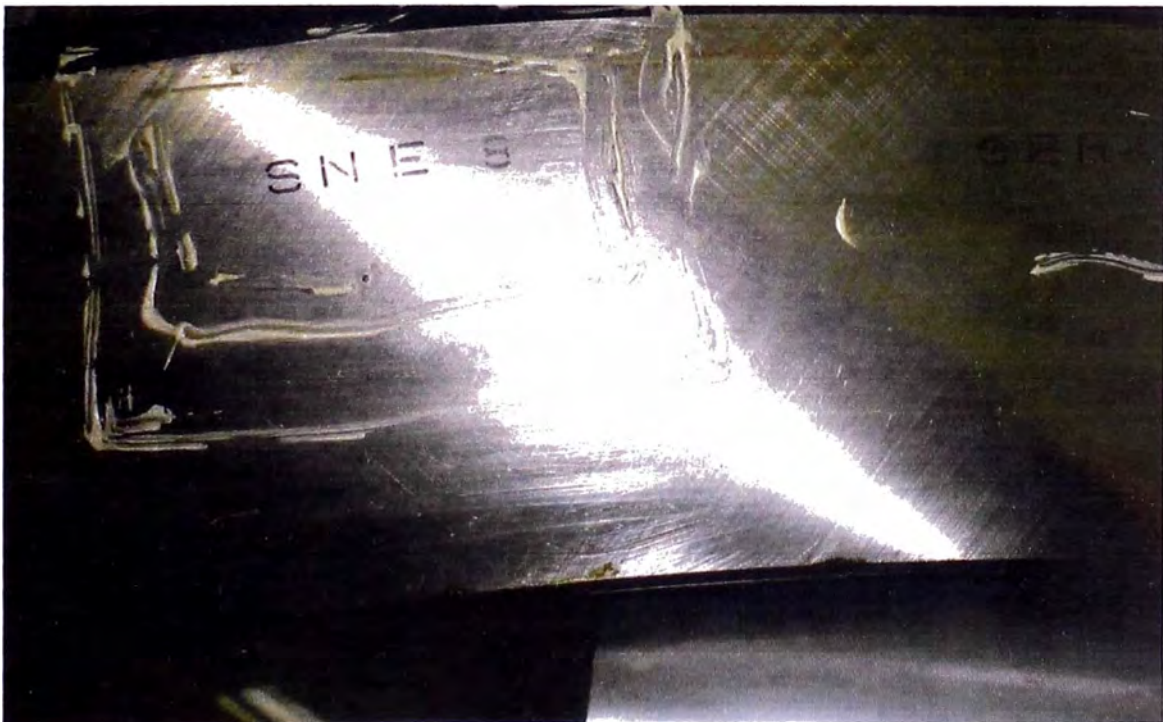
Fig. N°5.54 Número de serie SNE8 grabado en lateral de aro exterior.
