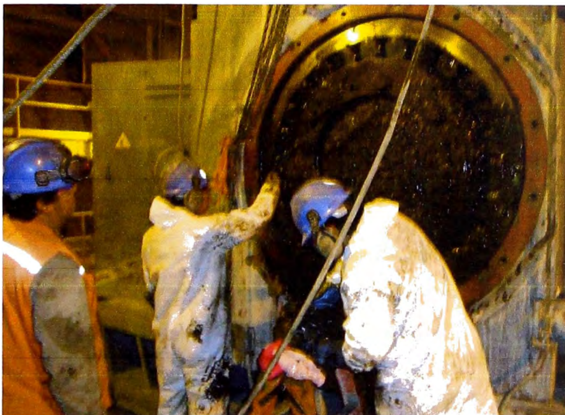
Fig. N°3.4 Inspección del estado de rodamiento exterior (D) de HPGR N°33.
