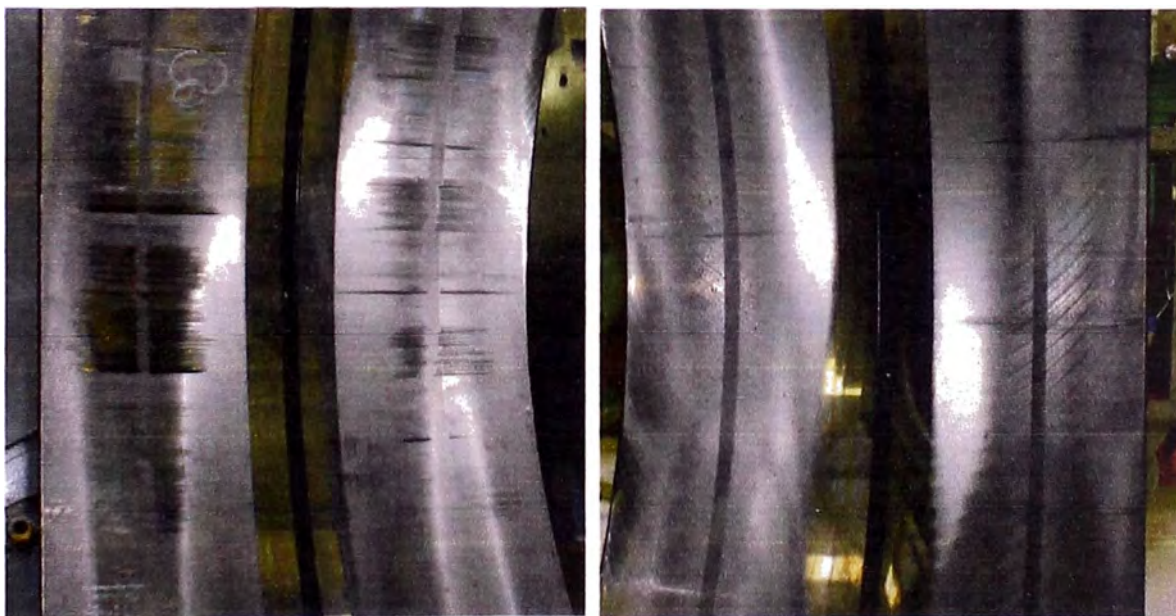
Fig. N°5.71 Desgaste con indentaciones en zona de carga.
