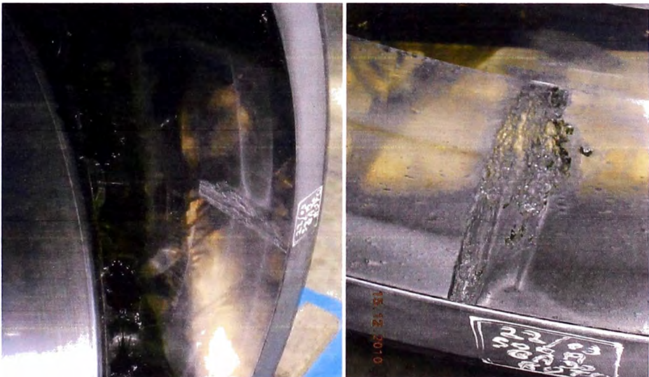
Fig. N°5.68 Descascarillado de material de pista por fatiga debido a contaminación.
