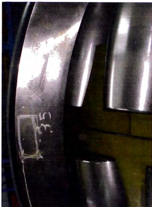
Fig. N°5.39 Número de serie SND35 grabado en lateral de aro exterior.
