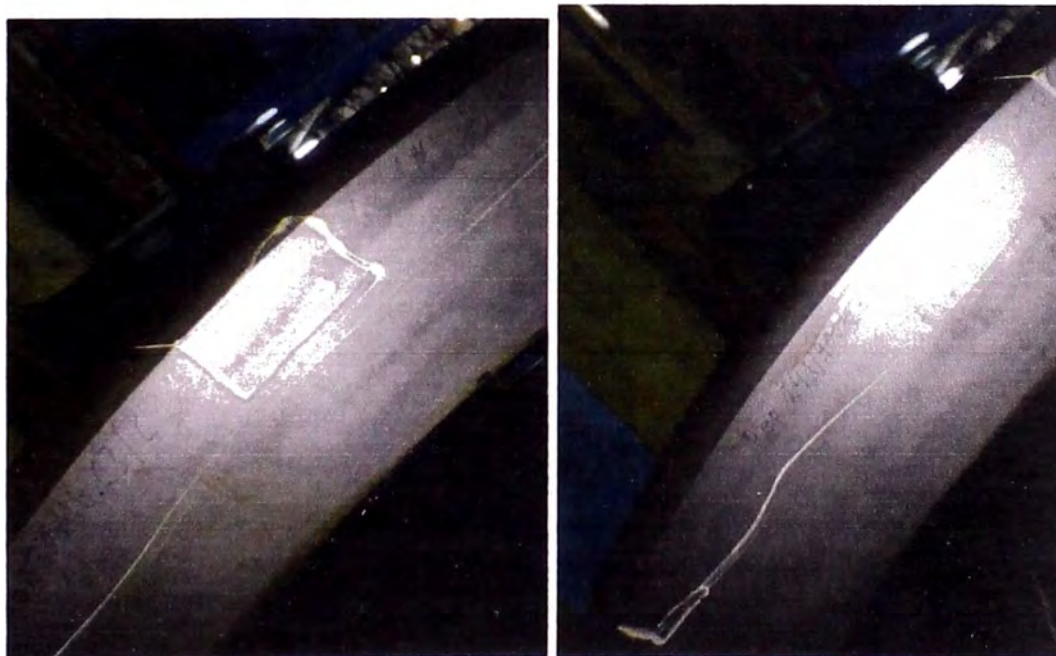
Fig. N°5.66 Número de serie SND576 y estado de reparación del rodamiento grabado con lápiz eléctrico en aro exterior.
