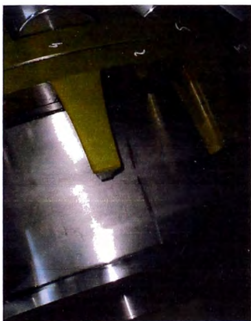
Fig. N°5.43 Desgaste uniforme en rodillo con marca de rozamiento con jaula.
