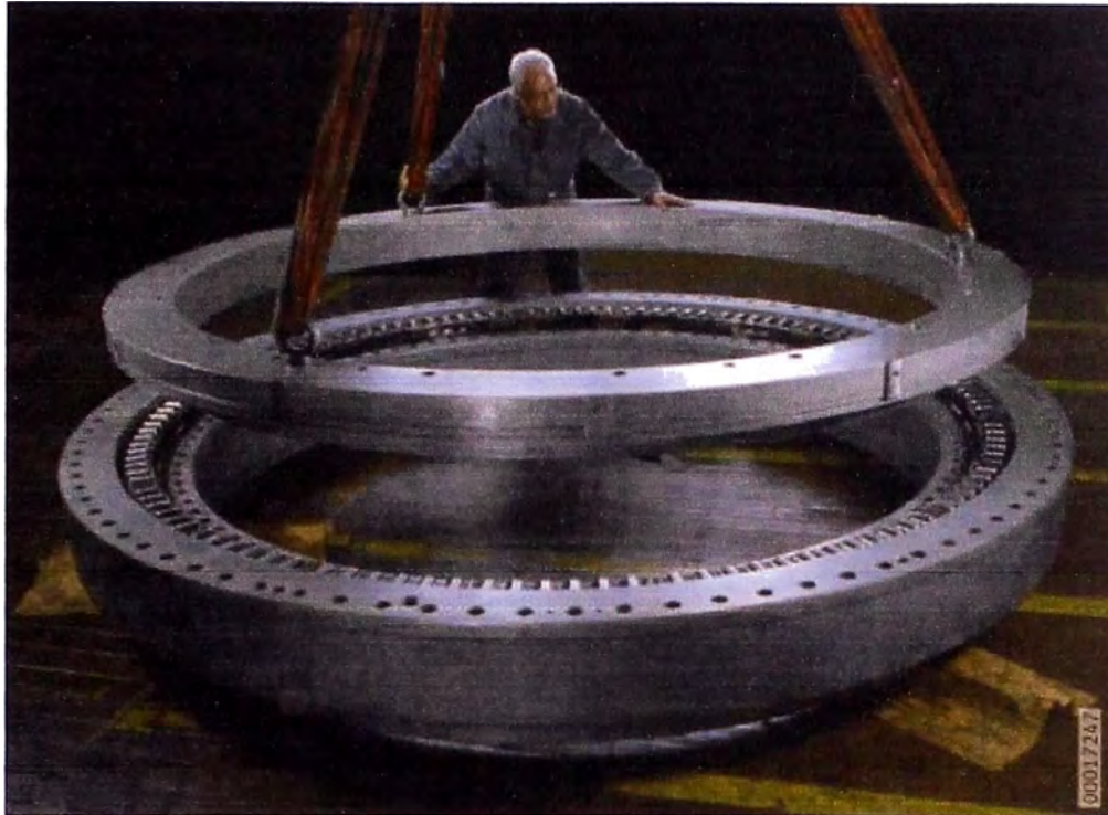
Fig. N°2.9 Proceso de montaje / armado del ensamble del nuevo rodamiento para embalaje.
