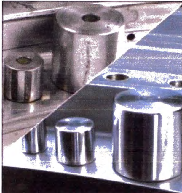
Fig. N°2.4 Reacondicionamiento de rodillos: Antes: Rodillos con marcas de corrosión e indentaciones de cuerpos extraños. Después: Nuevos rodillos con sobremedidas ajustadas.
