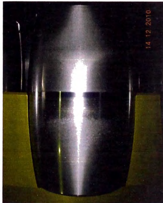
Fig. N°5.28 Indentaciones suaves y desgaste por contacto con jaula y lubricación deficiente.
