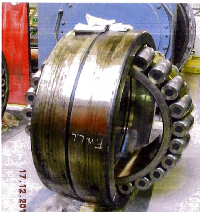
Fig. N°5.69 Oxido de contacto en asiento de aro exterior por defecto de ajuste.
