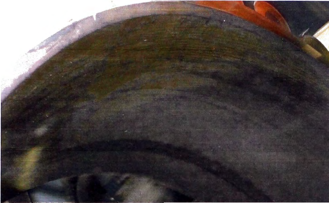
Fig. N°5.53 Desgaste con formación de óxido en agujero con microgiro en asiento de eje.
