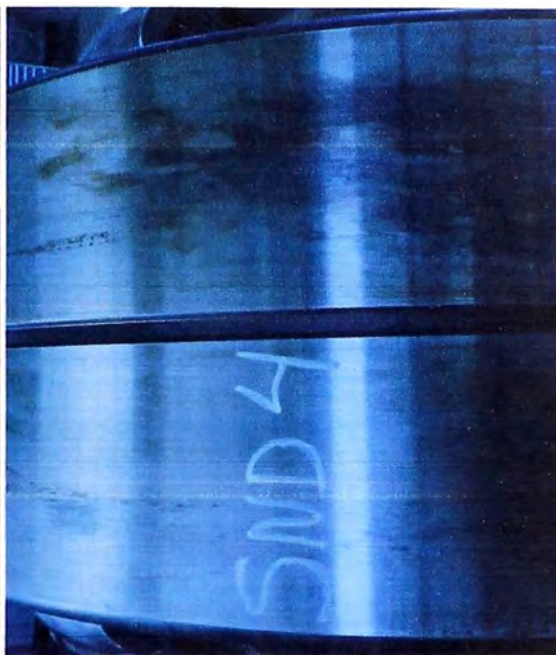
Fig. N°5.33 Corrosión de contacto en asiento de aro exterior por ajuste deficiente.
