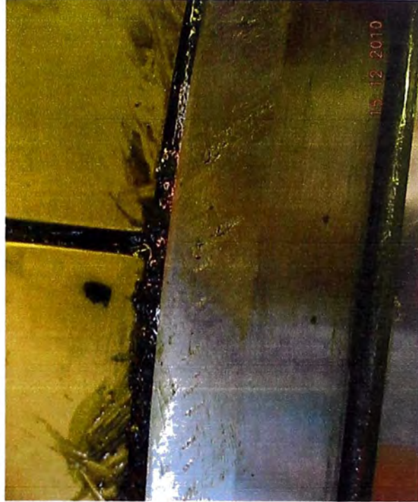
Fig. N°5.37 Desgaste lateral en arista de labio central de pista por contacto de atascamiento de rodillo (sobregiro).
