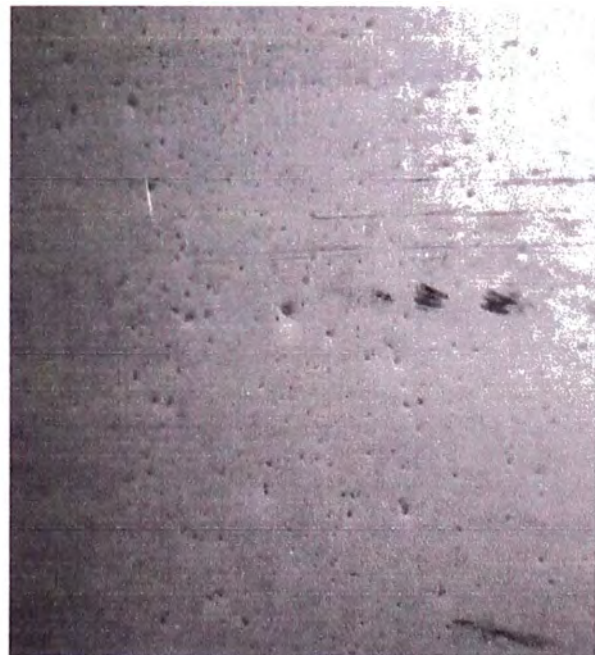
Fig. N°5.8 Desgaste normal y marcas de indentaciones suaves en pista de aro exterior debido a ingreso de contaminantes sólidos por obturación insuficiente.
