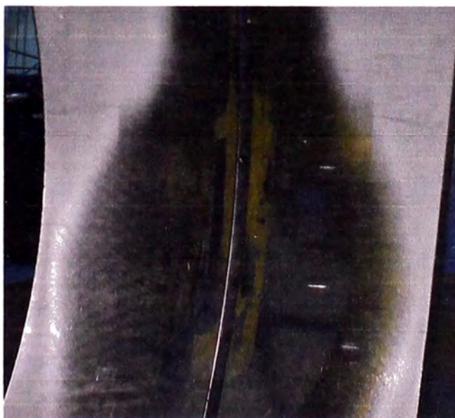
"standstill" debido a humedad en zonas de contacto.
