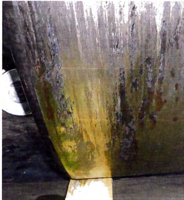
Fig. N°5.7 Marcas de corrosión de contacto en asiento de aro exterior, debido a desgaste en superficies por ajuste.
