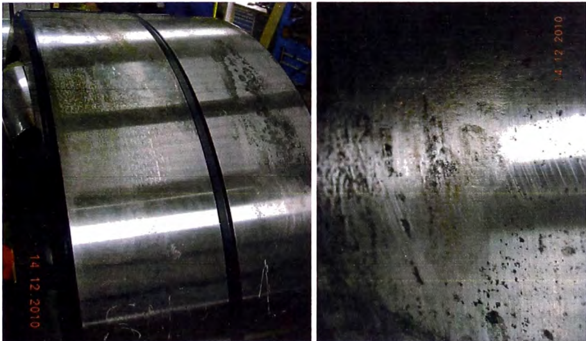
Fig. N°5.14 Oxidación de contacto en asiento de aro exterior y verificación de severidad con paso de lija suave sobre superficie dañada.
