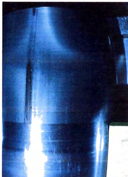
Fig. N°5.35 Indentaciones suaves y marca frontal de corrosión de contacto en rodillo por humedad.
