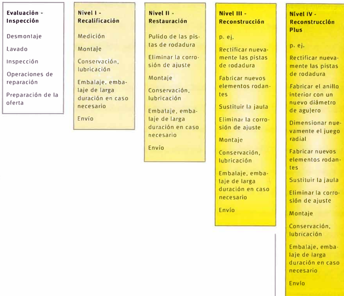
Fig. N° 4.9 Cuadro comparativo de las distintas etapas de reparación de rodamientos
