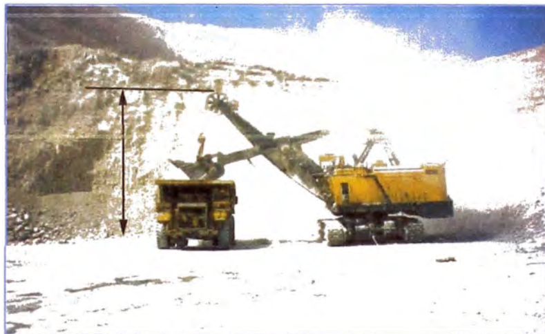
Figura 2.5. Carguío de una pala mecánica
