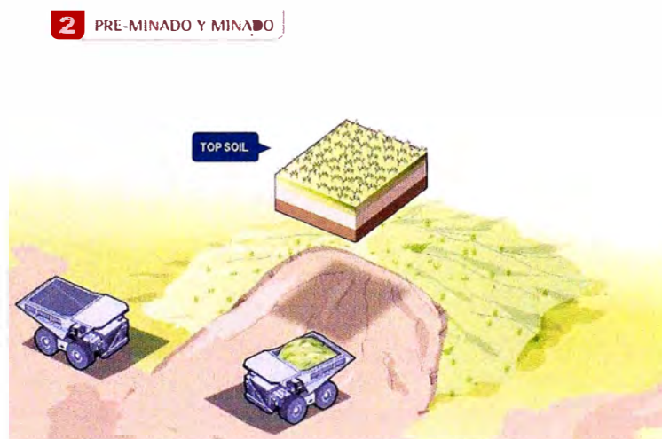
Figura 1.6. Retiro del Top Soil.
