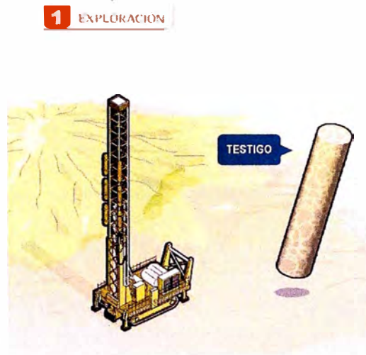
Figura 1.5. Perforación de la zona mineralizada.
