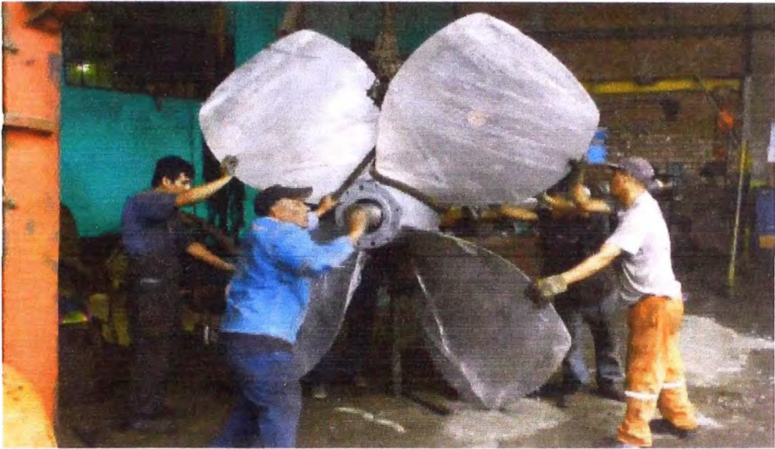
Figura 2.13 Asentado del cono de la hélice en eje propulsor
