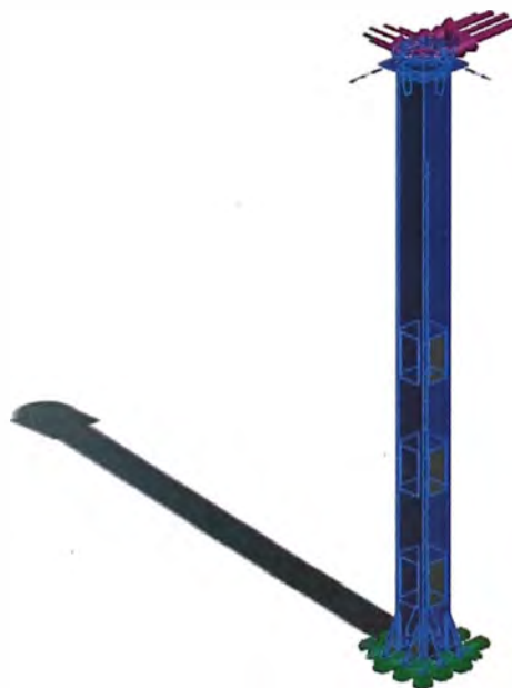
Fig. 5.4 Columna estructural de acero A36
