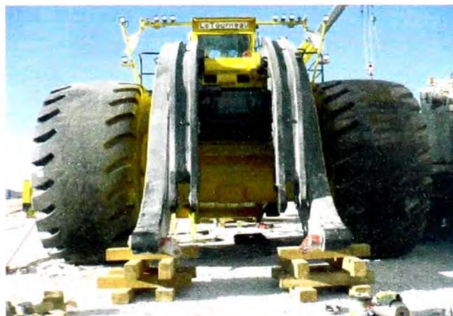
Fig. 6.27 Vista de brazos de levante ya colocados
