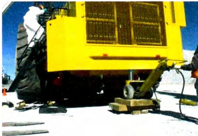
Fig. 6.24 Levantamiento de bastidor trasero
