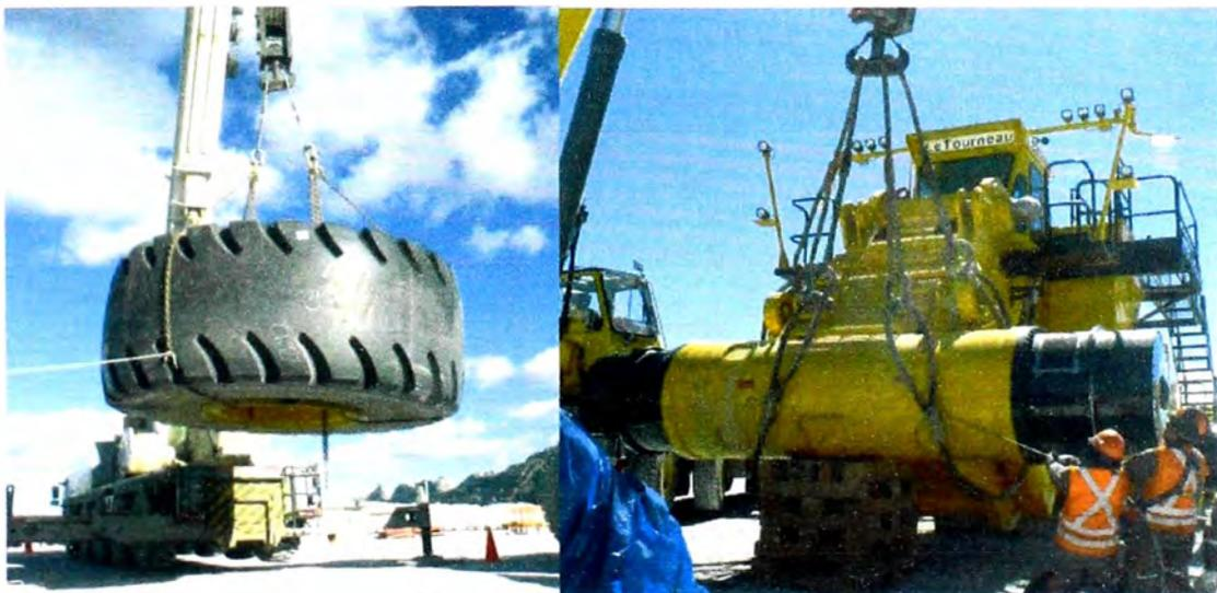
Fig. 6.17 Izaje de neumáticos y preparación del bastidor
