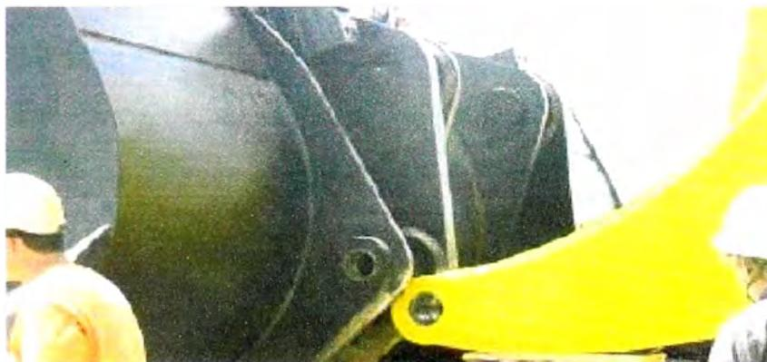
Fig. 6.31 Colocación de balde en brazos de levante
