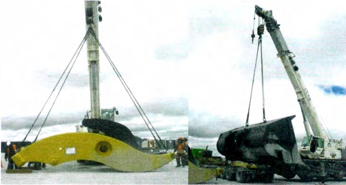
Fig. 6.4 Descarga del brazo de levante y del balde.
