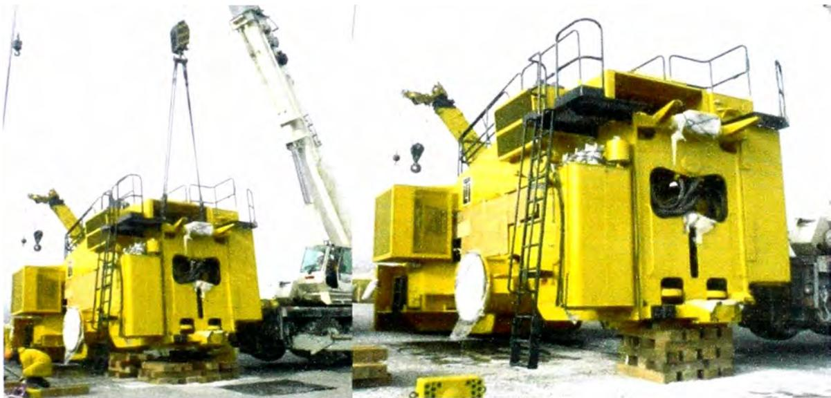
Fig. 6.7 Ubicación de bastidor trasero sobre durmientes
