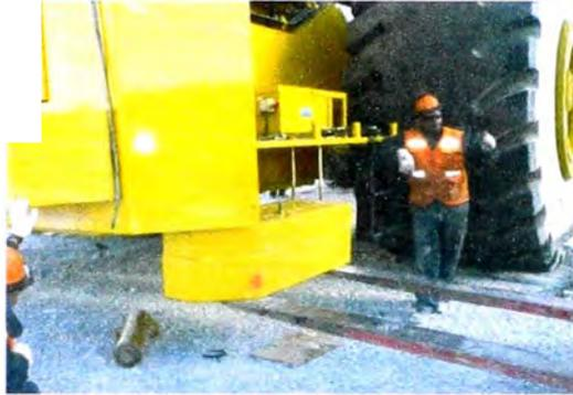
Fig. 6.32 Colocación de contrapeso
