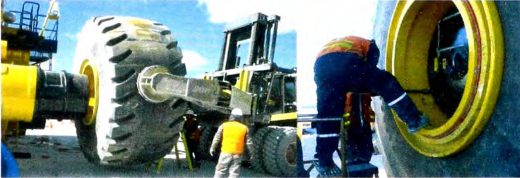
Fig. 6.18 Instalación de neumáticos
