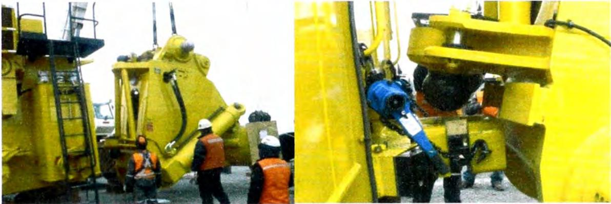
Fig. 6.10 Unión de bastidores
