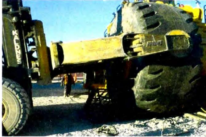
Fig. 6.23 Instalación de neumático trasero.
