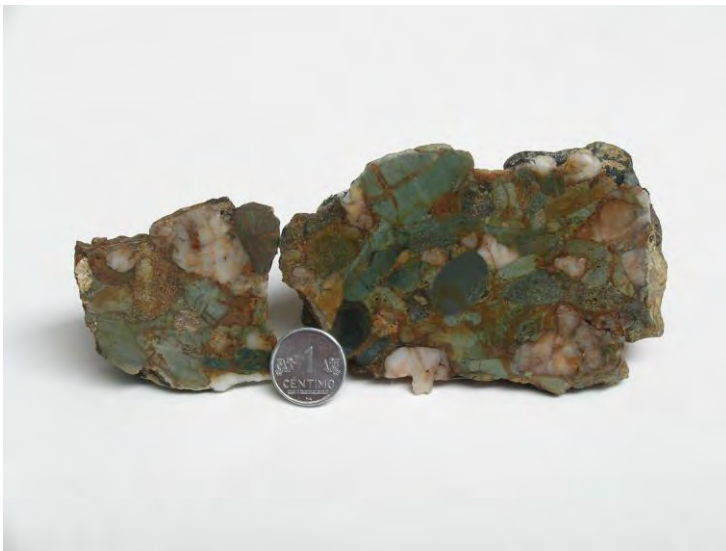
Foto 14.- Corte del conglomerado, mostrando con mayor detalle sus componentes líticos, cementados por cuarzo ferruginoso.
