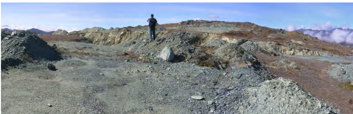
Foto 38.- Vista parcial con dirección Norte, del área de San Felipe, mostrando las canchas donde se depositaba el material extraído, para su posterior selección (Pallaqueo).
