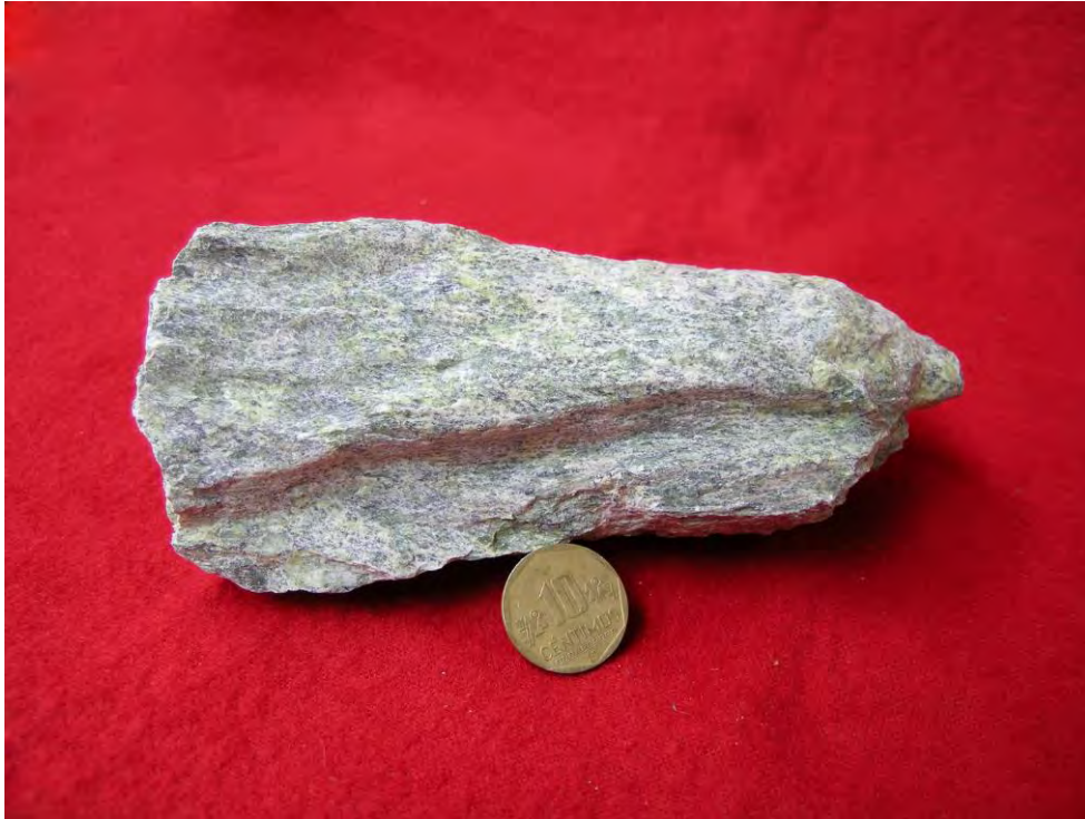
Foto 49.- Vista de otra muestra de 'serpentinita verde amarillenta'. El talco se encuentra a modo de impregnaciones recubriendo la roca.
