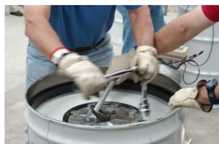
Personal GTRI e IPEN operando y Confección final del cilindro de transporte
