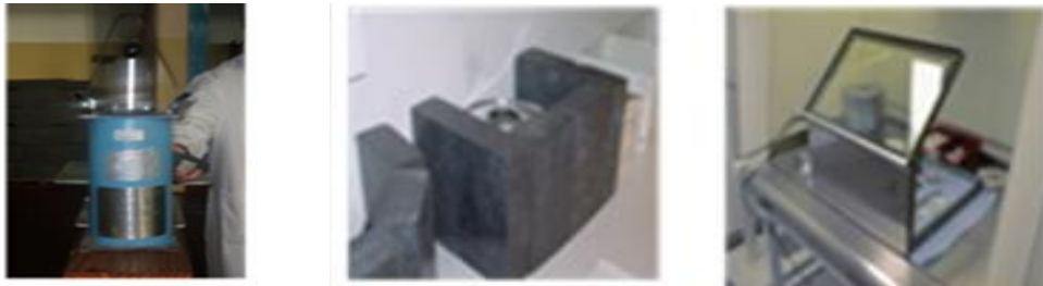
Blindajes: porta muestra, cabina de ladrillos de plomo y visor plomado.
