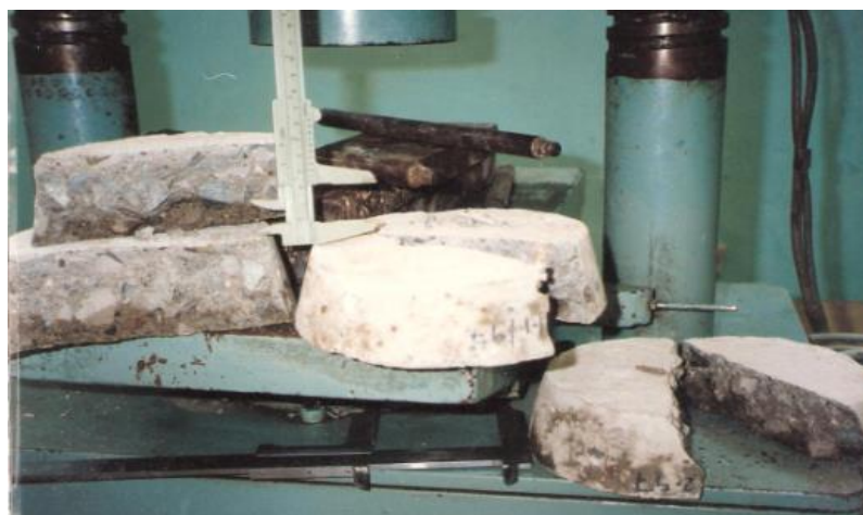
Foto No 15. Pesado de las muestras de permeabilidad, antes y después
