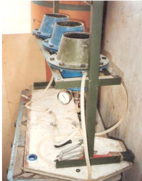
Foto No 14. Muestra de capa mojada en prueba del concreto, 3 días de ensayo.
