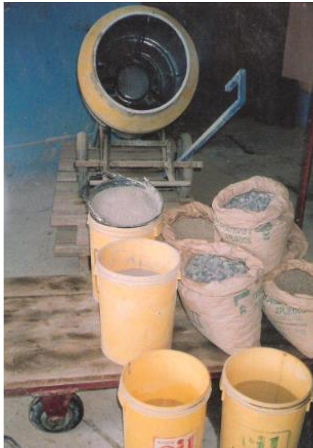
Foto No 3. Diseño de mezclas, dosificación rutinaria de agregados.
