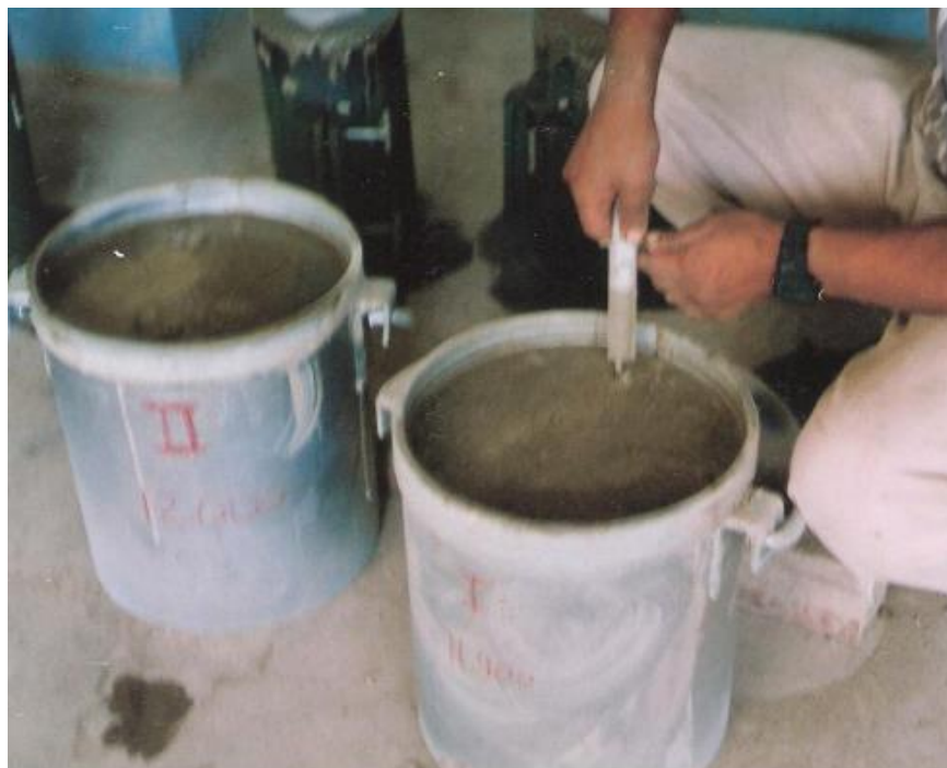
Foto No 4. Toma de muestras para el concreto fresco: Exudación
