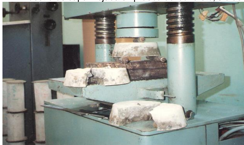
Foto No 14. Muestra de capa mojada en prueba del concreto, 3 días de ensayo.
