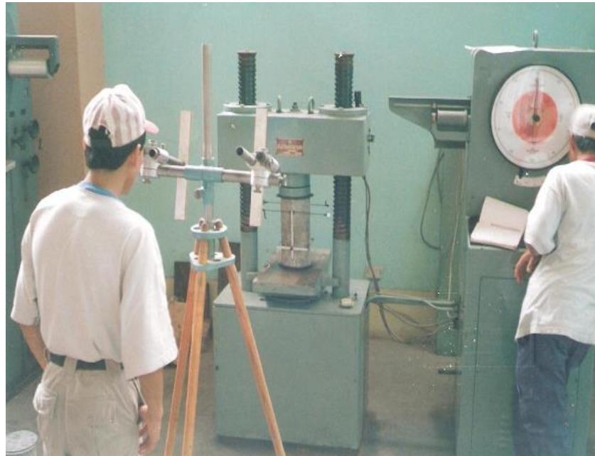
Foto No 9. Ensayo de rotura del concreto para resistencia y módulo de elasticidad estática.
