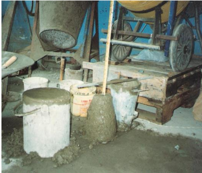
Foto No 5. Toma de muestras para el concreto fresco: Asentamiento y Peso unitario del concreto fresco.
