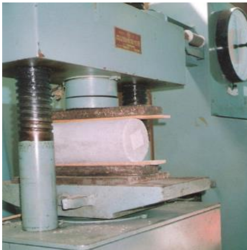
Foto No 10. Ensayo de rotura del concreto para tracción por compresión diametral.
