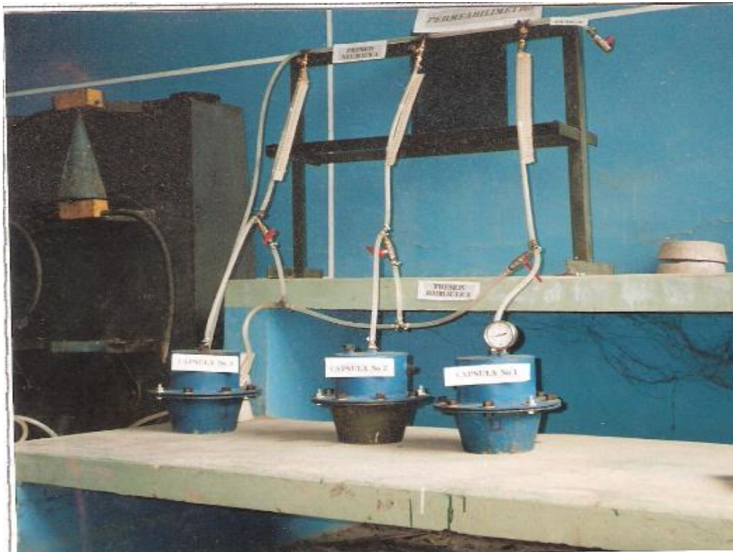
Foto No 1. Sistema de medición de la permeabilidad propuesto, anotando las capsulas de presión manómetro y conjunto de llaves de manipulación hidráulica.
