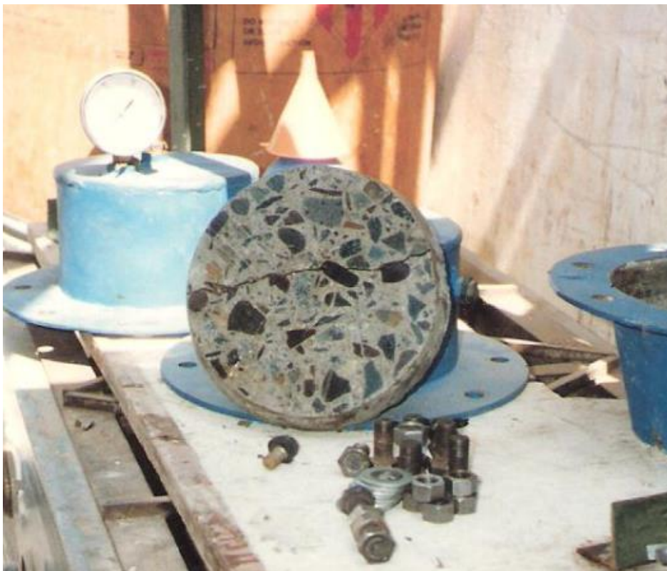
Foto No 16. Corte diamantino de la muestra de concreto endurecido destinada a la permeabilidad.
