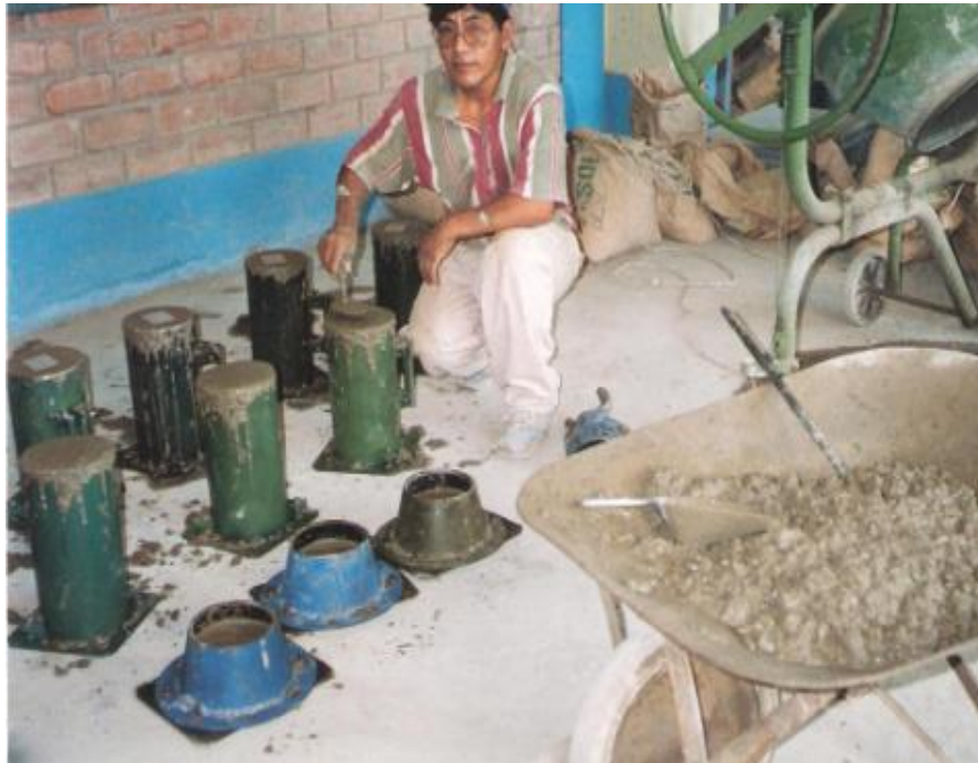
Foto No 7. Toma de muestras para el concreto endurecido: Resistencia y Permeabilidad.
