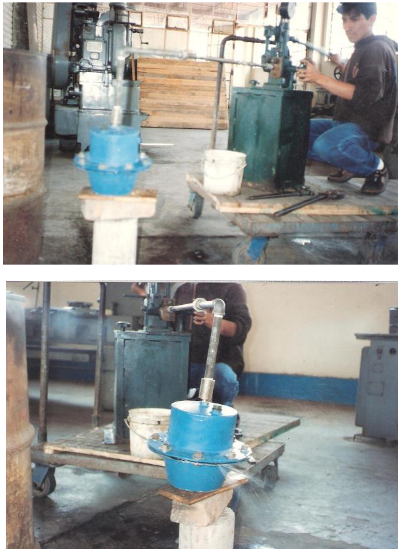
Foto No 12. Puesta a prueba hidráulica en el laboratorio No 1 de la facultad de mecánica.
