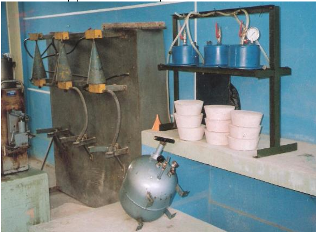
Foto No 2. Equipo de medición de la permeabilidad con muestras de concreto
