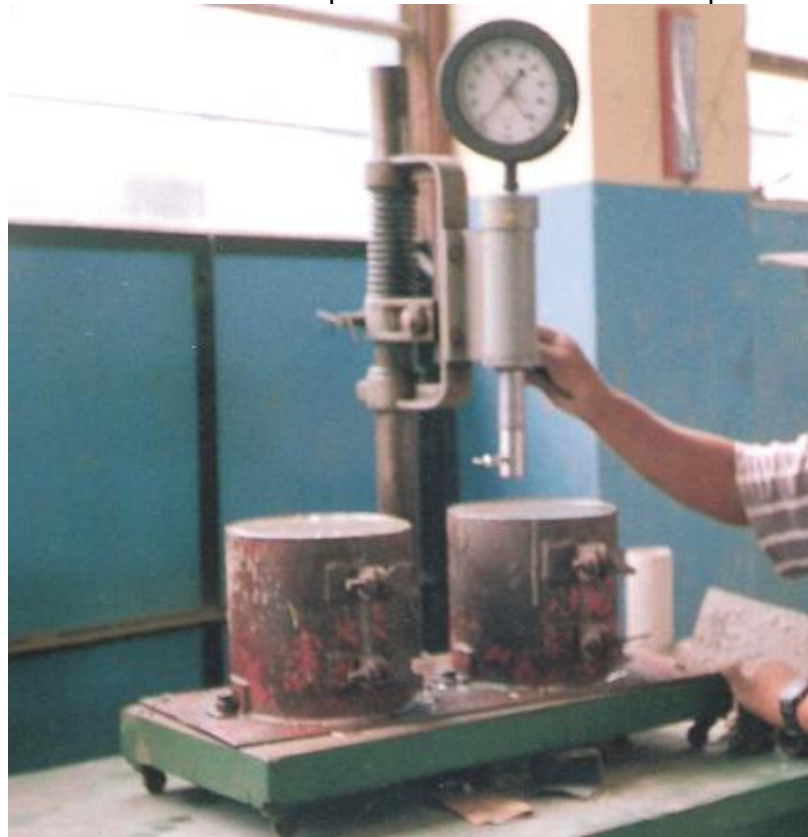
Foto No 6. Toma de muestras para el concreto fresco: Tiempo de Fraguado.
