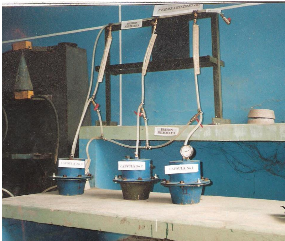
Figura Nº 46: Equipo de medición de la Permeabilidad: capsulas
