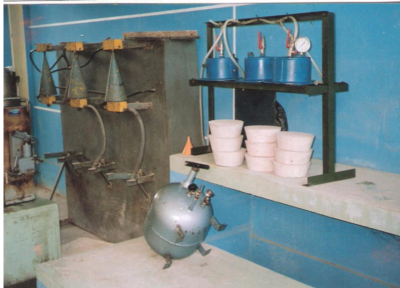
Figura Nº 47: Equipo de medición de la permeabilidad y muestras de concreto.
