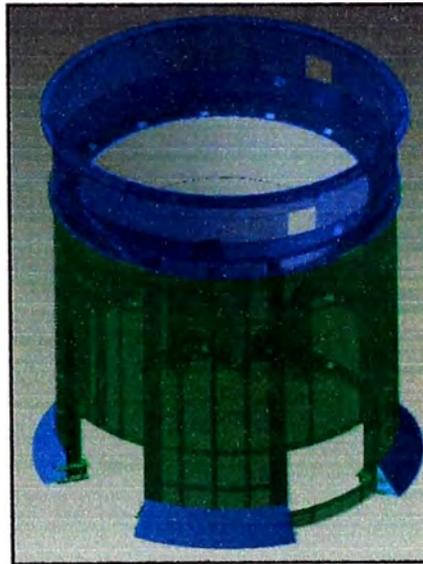
Fig. 3.12: Montaje del Cono de Descarga
