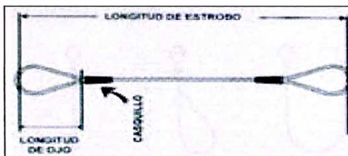
Fig. 2.27: Estrobo de Cable de Acero.
