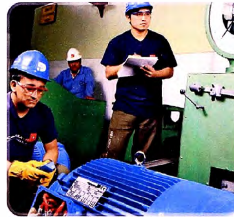
• Prueba al Freno dinámico motor hasta 150 HP de acuerdo a prescripciones IEEE - 112
