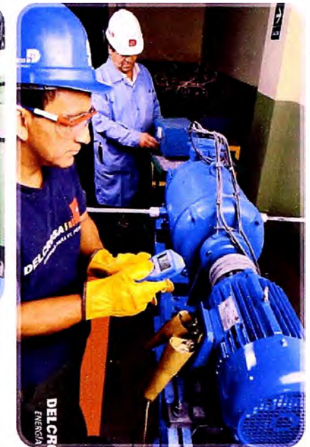
• Ensayo de Calentamiento motor < 10 HP de acuerdo a prescripciones IEEE - 112
