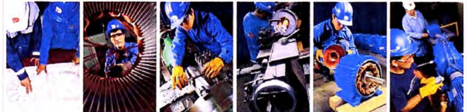
Ingeniería Bobinado Esmerilado Torneo de escudo Montaje Pruebas según IEEE-112
