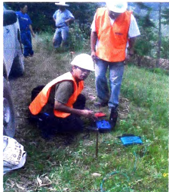
Medición de la resistividad del terreno con el Telurómetro
