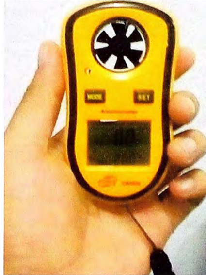
Figura N°4. 28: Anemómetro-termómetro digital GM816-30m/s (65MPH)-BENETECH.
