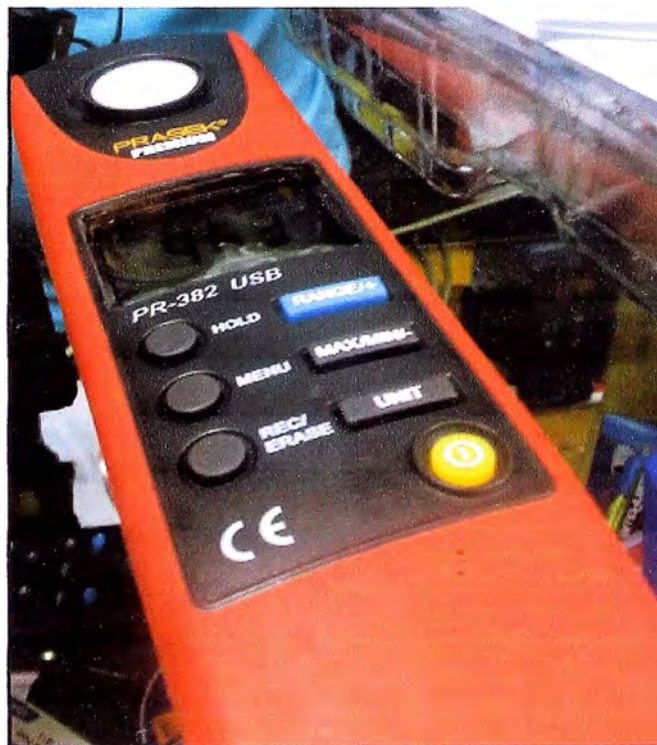
Figura N°4. 47: Luxómetro (mide intensidad de luz) 20000 Lux Prasek Pr-382 Fuente: Elaboración propia
