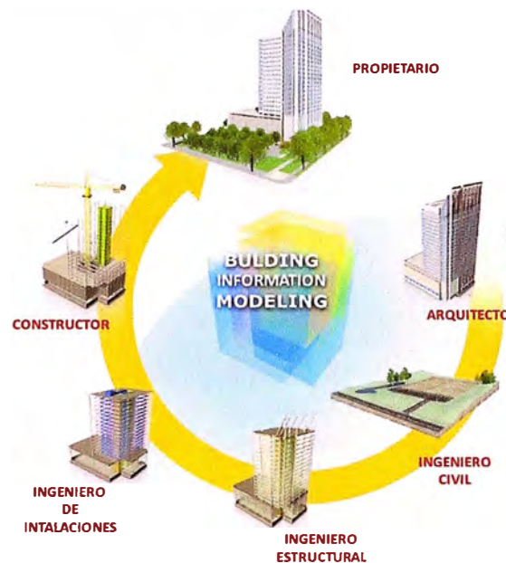
Figura N° 2. 3 Ciclo de vida de una edificación
