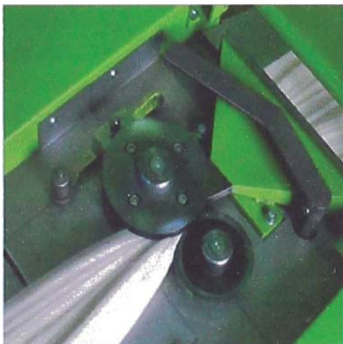
Figura N° 40: Vista del sistema de autoregulación para el pasaje 1 CSN/UV11.
