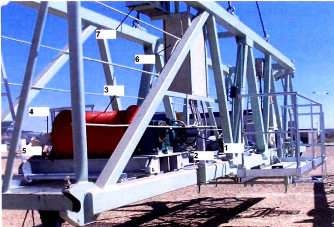
**Figura 3 - Mecanismo de Traslación del Carro**
