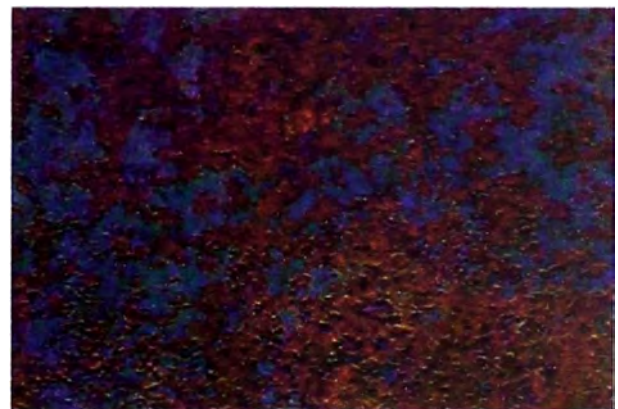
Figura 4.3 – Corrosión grado B.
