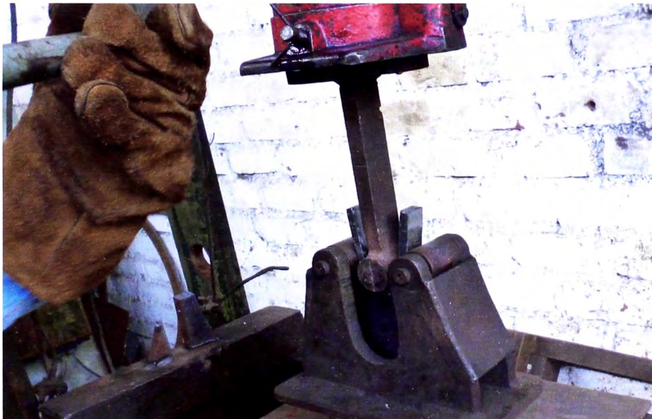
Figura 4.15 – Prueba de dobles a una probeta de soldadura.
