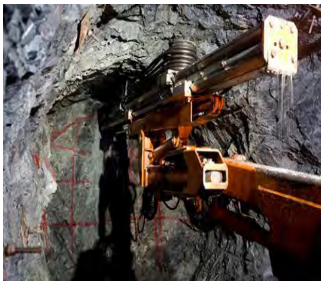
Figura 3.5: Trazo para voladura de pique principal
