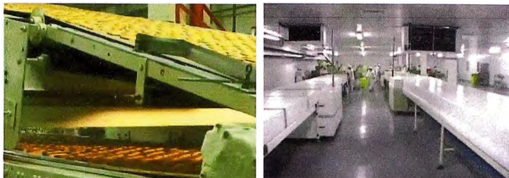
Fig. 2.8 Enfriamiento en fajas y túneles de enfriamiento
