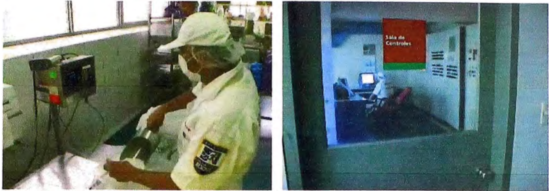
Fig. 2.4 Preparación de ingredientes y selección de recetas por el sistema de supervisión, control y adquisición de datos (SCADA)
