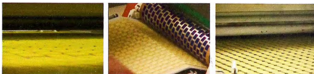
Fig.2.6 Masas laminadas (1), roto moldeadas (2) y extruidas (3)
