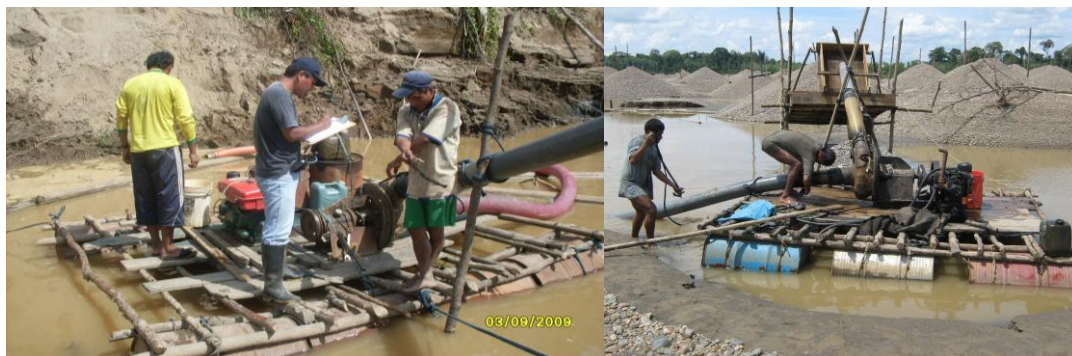
Figura N° 15: Método de Carrancheras y de Chupaderas
