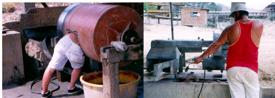
Figura N° 52: Limpieza de una “chancha” luego de la amalgamación y quemado afuera de un horno o recuperador de Hg en Portovelo-Zaruma
