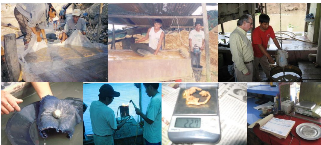
Figura N° 19: Proceso de amalgamación usando mercurio
