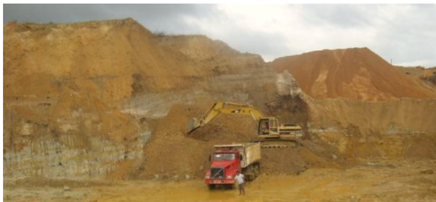
Figura N° 18: Método de explotación a Tajo Abierto
