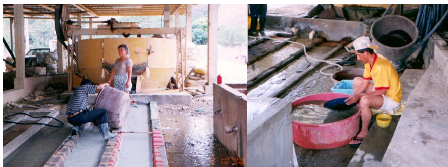
Figura N° 51: Trapiche tipo chileno para molienda del mineral y Minero pre-concentrando oro para amalgamarlo en Portovelo-Zaruma
