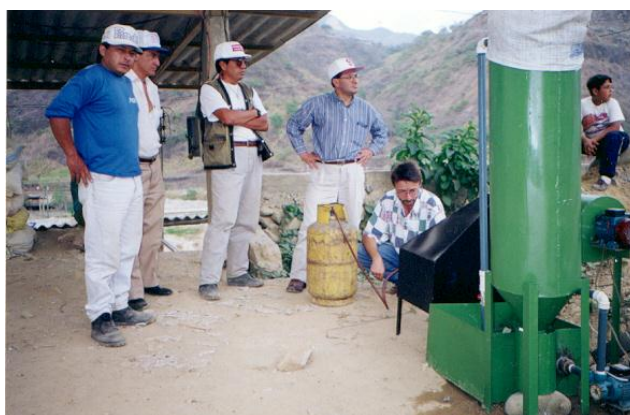
Figura N° 53: Horno para quema de amalgama desarrollado por COSUDE
