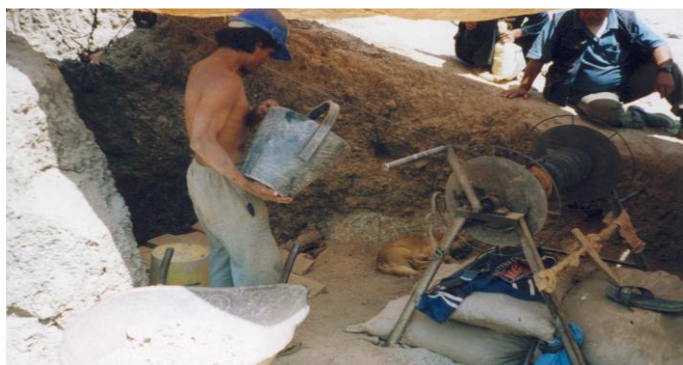
Figura N° 35: Extracción de mineral usando winches manuales
