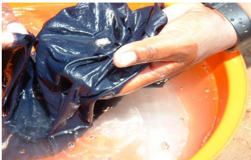
Figura N° 30: Recuperación de oro con amalgamación
