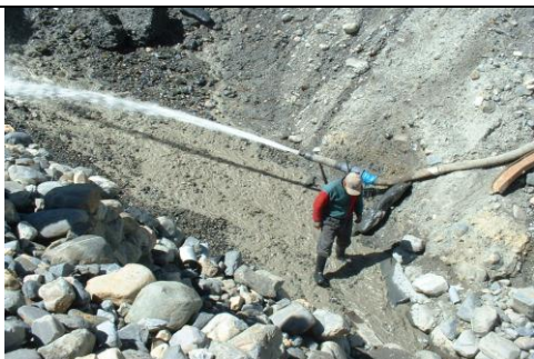
Figura N° 24: Método de Monitores
