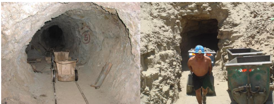
Figura N° 36: Carro Minero sobre rieles y ruedas para extraer mineral
