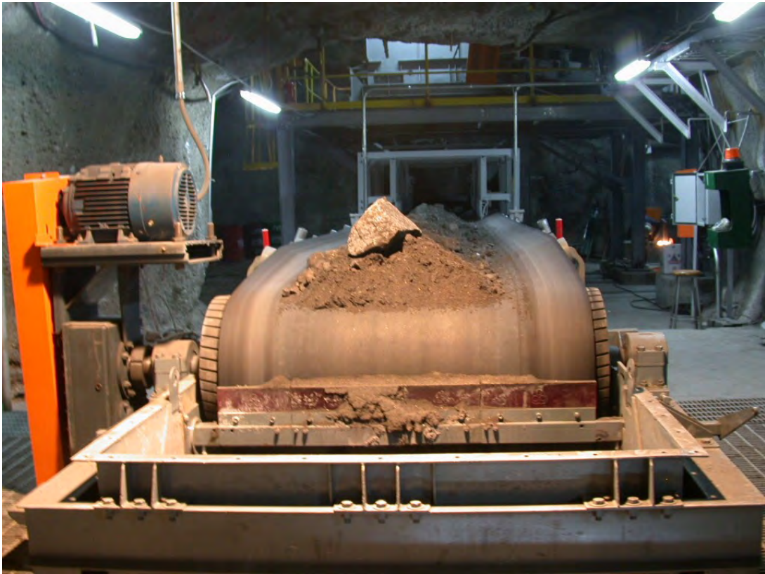
Faja que transporta mineral (Nivel -1205)
