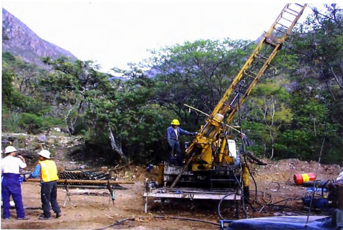
Fig. 41: Perforación Diamantina en Machicucho. Máquina Long Year 44, montada sobre camión. Obsérvese la vegetación que cubre el lugar.
