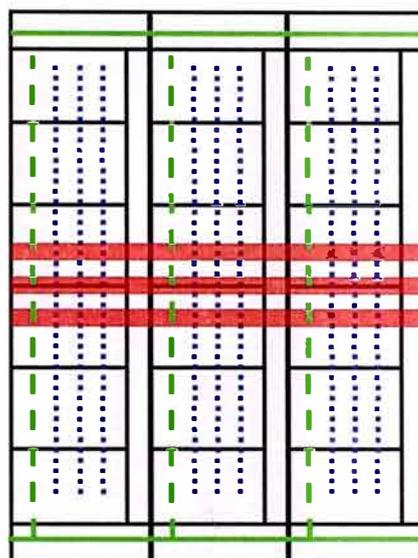
**FIGURA 2.5.** Esquema de distribución de barras eléctricas del CCM.
