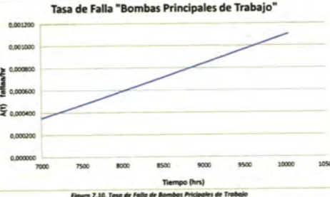
Figura 7.10. Tasa de Fallo de Bombas Principales de Trabajo
