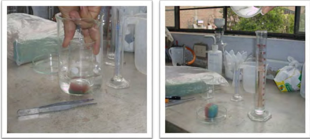
Figura N° 5.20. Luego de absorbida se deja la esponja en un recipiente para hallar el volumen de agua desplazada
