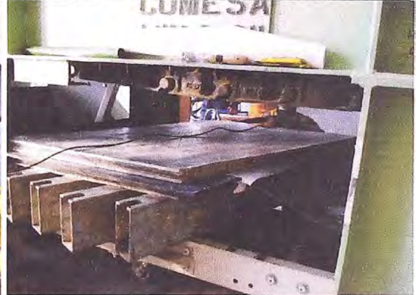
Foto 16: Vulcanizado del empalme de fajas realizado por empresa subcontratista
