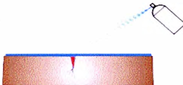
Fig. 4. 34: Aplicación de removedor.
