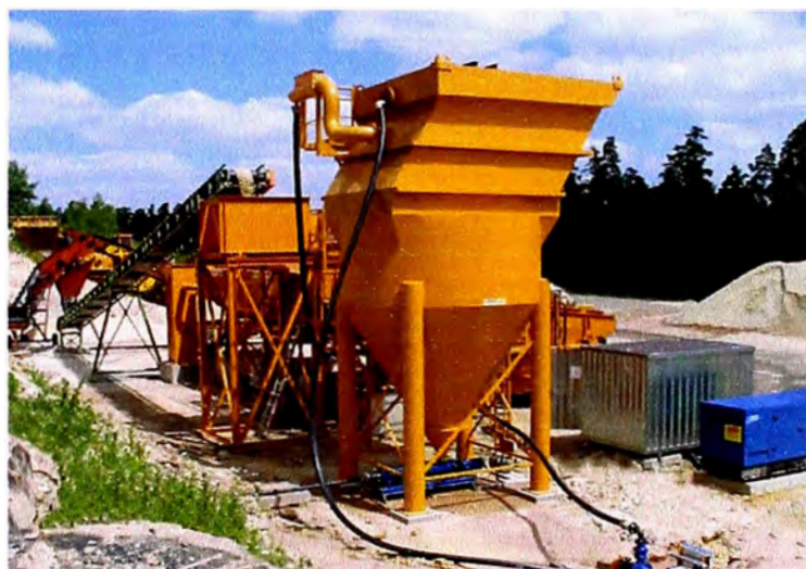
Fig. 1. 2: Tanque espesador de láminas.
