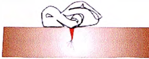
Fig. 4. 33: Retiro de exceso de líquido penetrante.
