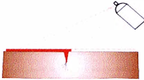
Fig. 4. 32: Aplicación de líquido penetrante.
