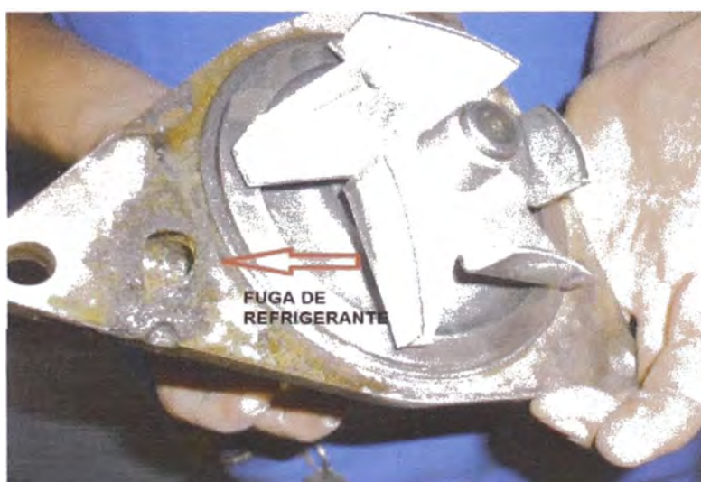
Figura 31: Bomba de agua reportada como defectuosa por fugas en el retén.
