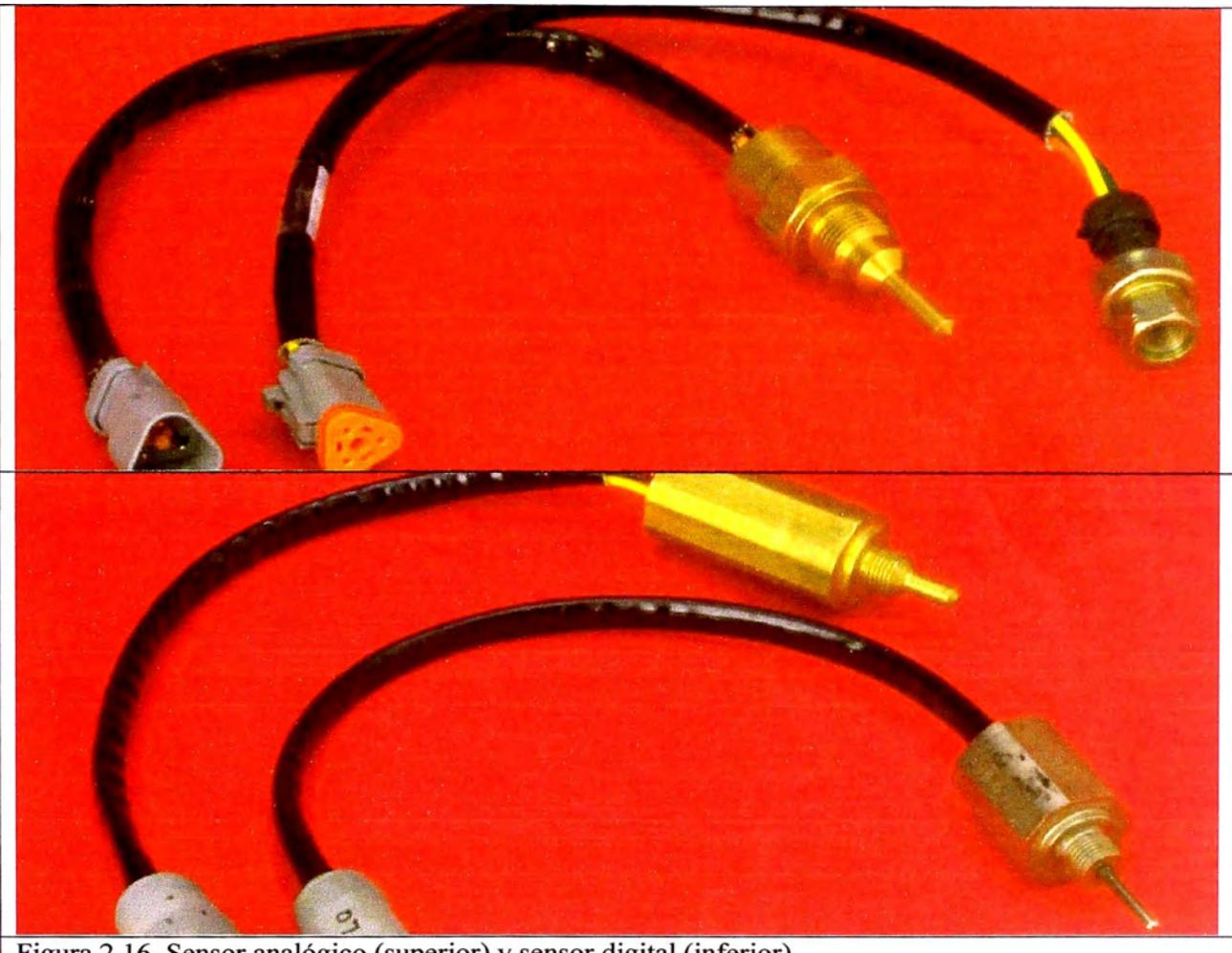
Figura 2.16. Sensor analógico (superior) y sensor digital (inferior)
