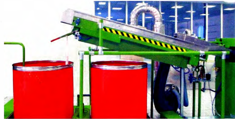
Dämpfeinheit und Ablieferung, Kühlband Steaming device and delivery, cooling conveyor
