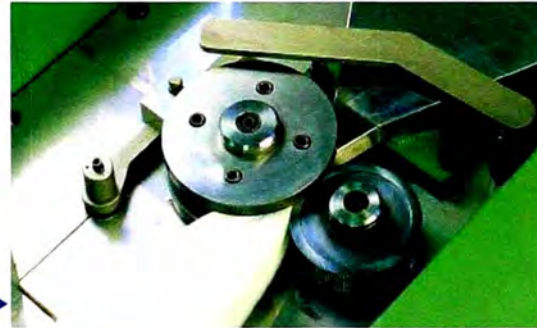
Autoregolatore ARE: (opzionale secondo i processi) ARE auto-leveller (optional - depends on processes)
