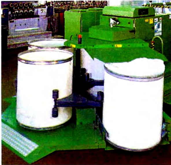
Uscita a giostra (V12GP): espulsione vasi verso sinistra Revolving delivery (V12GP) with left can ejection
