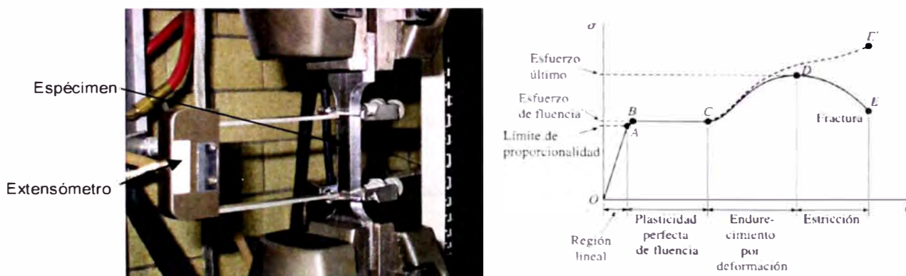
Figura N° 2.11. Prueba de esfuerzo de tensión uniaxial.
