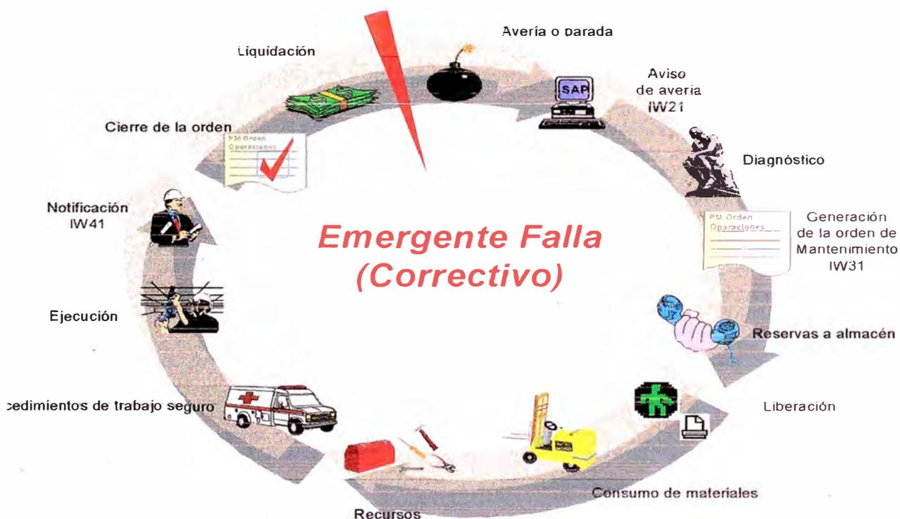
Figura.- Ciclo del mantenimiento Emergente Falla
