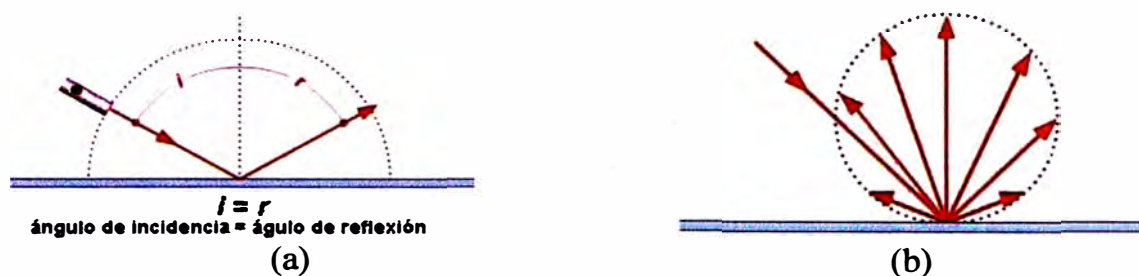
Figura 2.7 Reflexión Luminosa (a) Reflexión Especular (b) Reflexión Difusa
