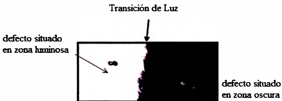
Figura 3.23 Dos defectos situados a ambos lados de la transición de luz
