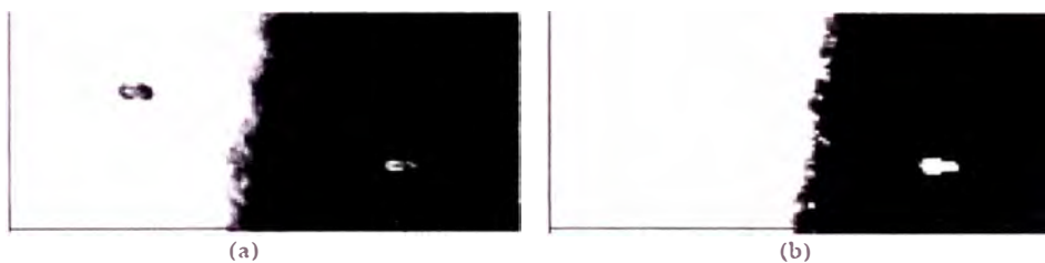
Figura 3.34 Defectos situados a ambos lados de la transición de luz. (a) Intensidad luminosa sin saturación de cámara (b) Intensidad luminosa con saturación de cámara.
