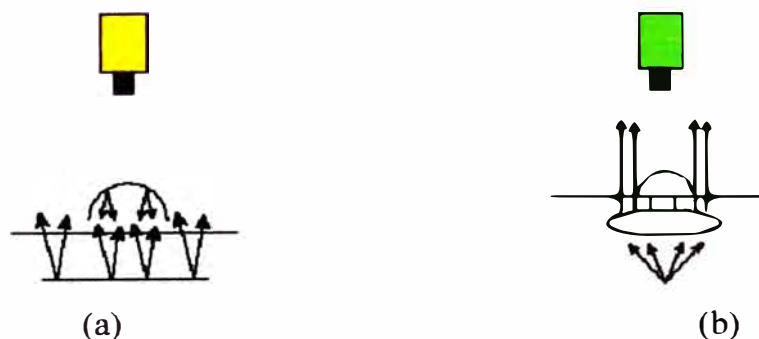
Figura 2.12 (a) Iluminación posterior difusa (b) Iluminación posterior direccional
