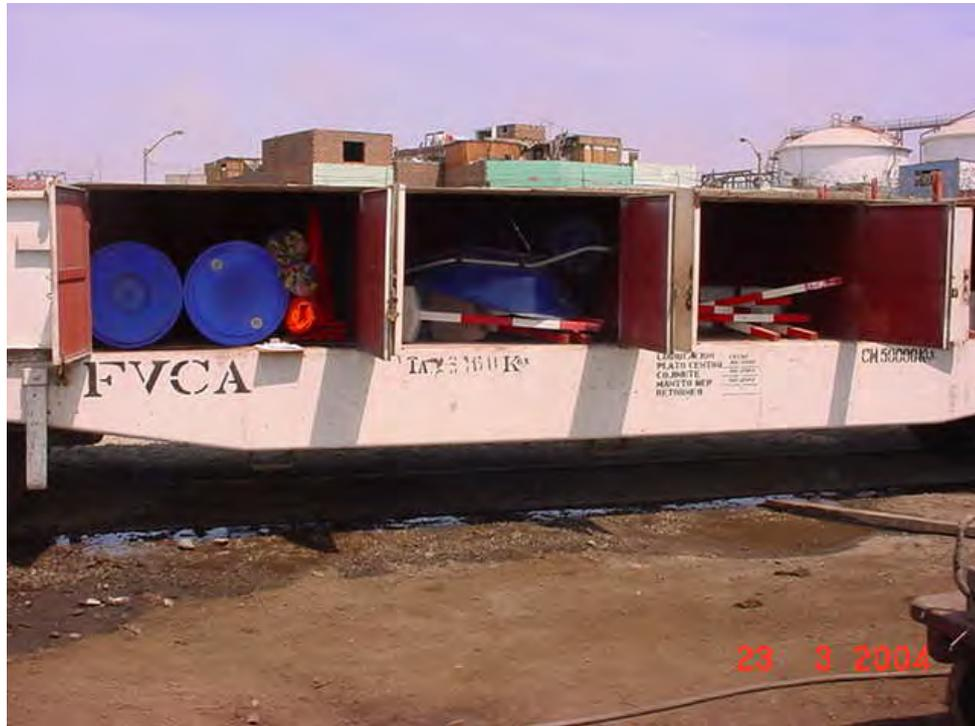
Fig. 35 Carro vagón de auxilio, conteniendo equipos y materiales para incidentes con sustancias químicas peligrosas.
