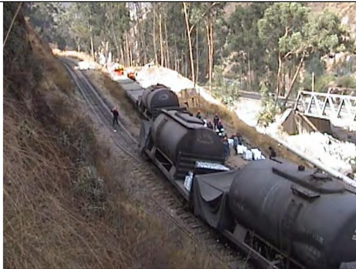
Fig. 19 Descarrilamiento de tanques con refinados de cinc
