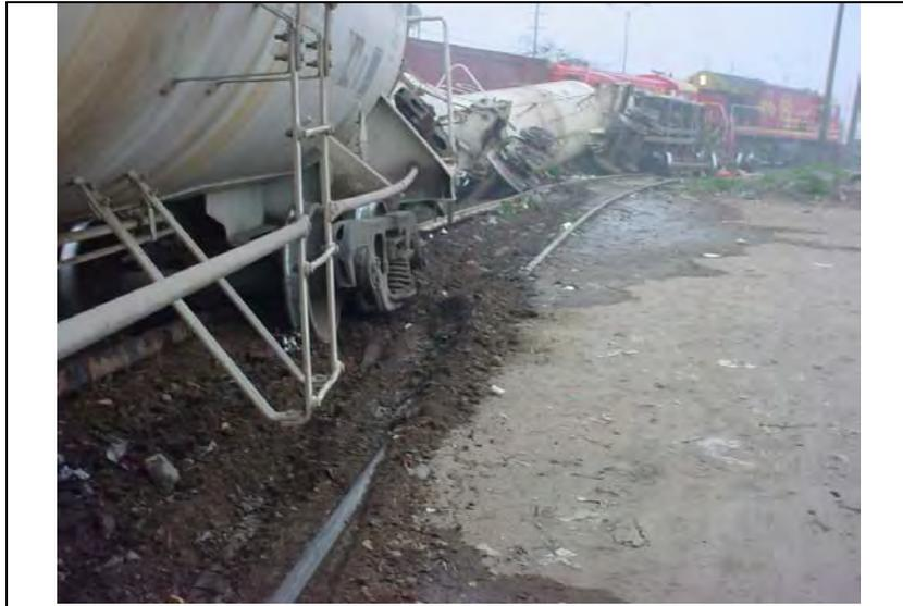
Fig. 18 Descarrilamiento de tanques de acido
