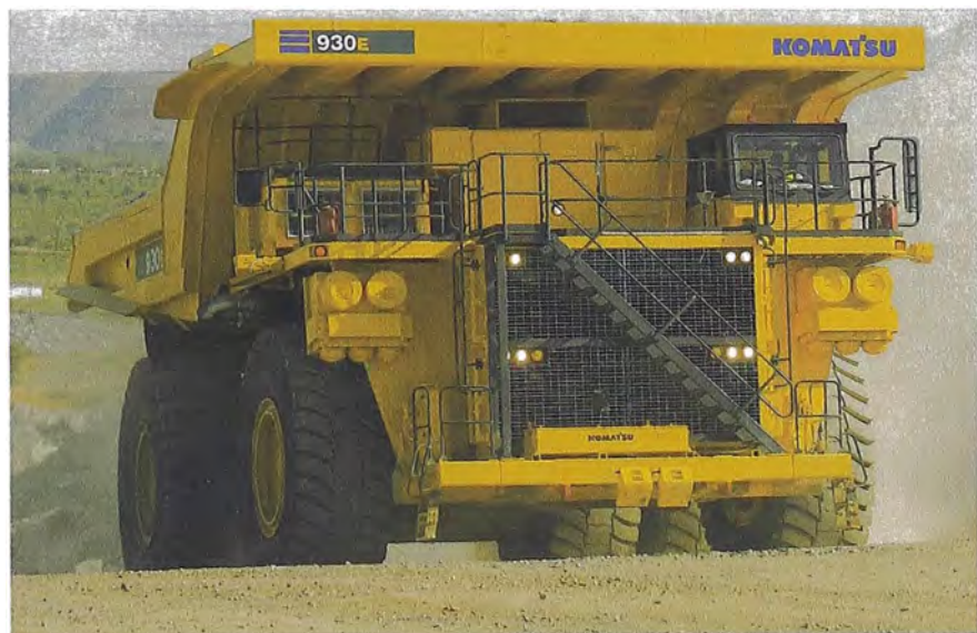
Figura 2.2: Komatsu 930E-4SE de 290 toneladas métricas.
