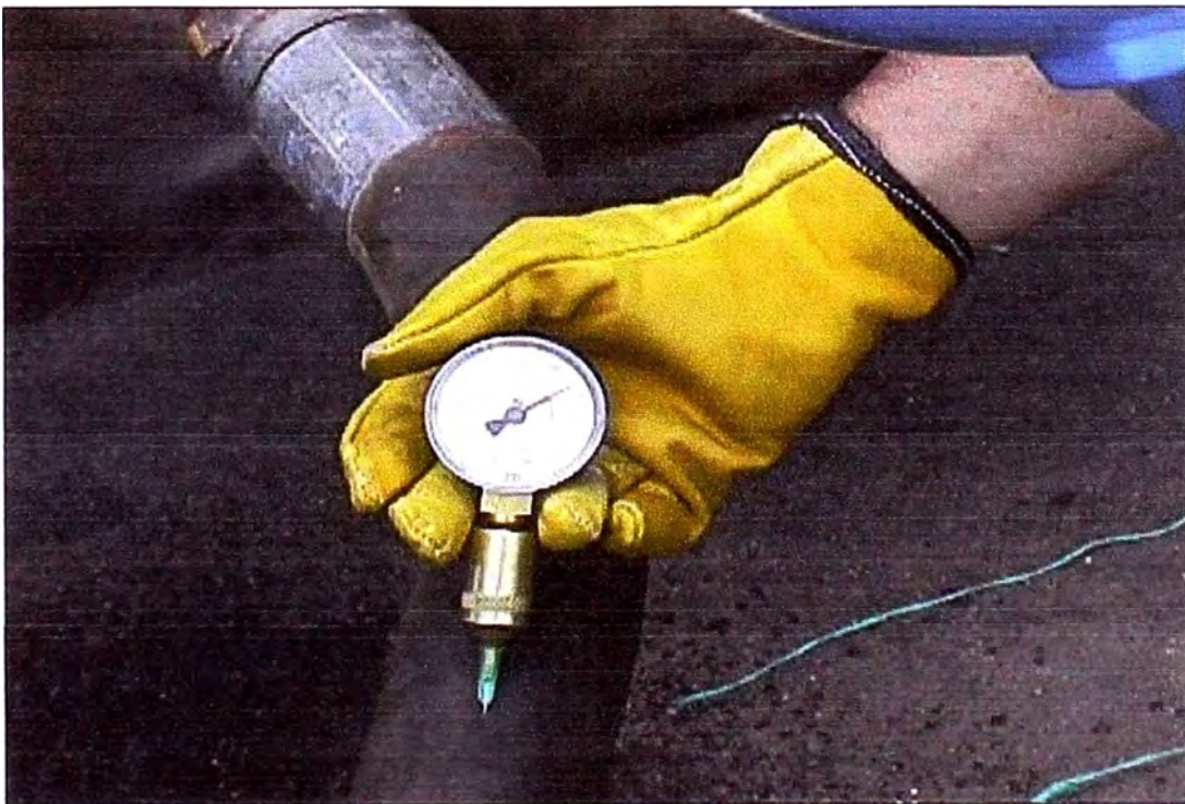
Fig. 4.11 Manómetro con aguja Hipodérmica
