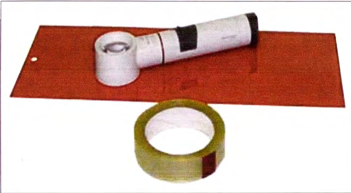
Fig. 4.17 Kit de prueba de verificación de contaminación por polvo del sustrato
