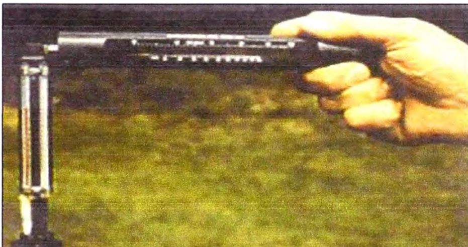
Fig. 4.26 Sling Psychrometer, usado para medir la Humedad relativa
