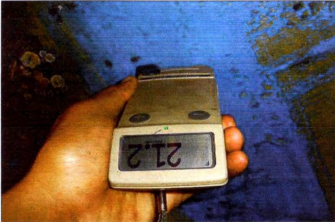
Fig. 4.31 Medidor de espesores de película seca (Positector)
