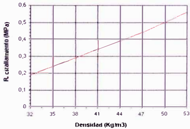
Resistencia al cizallamiento en función de la densidad, según DIN 53 427
