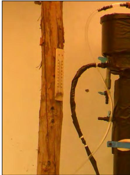
**Fotografía N° 5.10: Termómetro ambiental ubicado cerca del reactor UASB**
