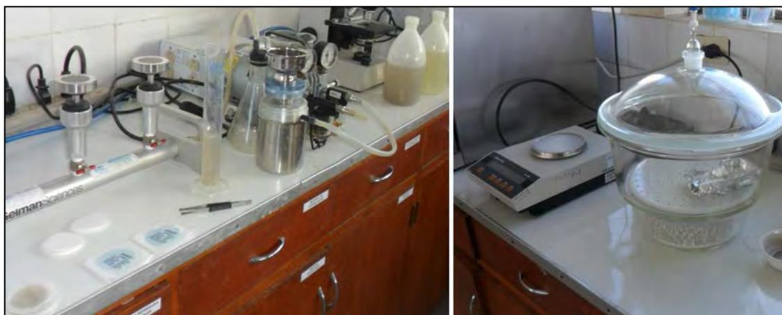
**Fotografía N°5.15: Equipo de filtración, filtros y muestra de agua residual y tratada (izquierda), desecador y balanza digital (derecha)**
