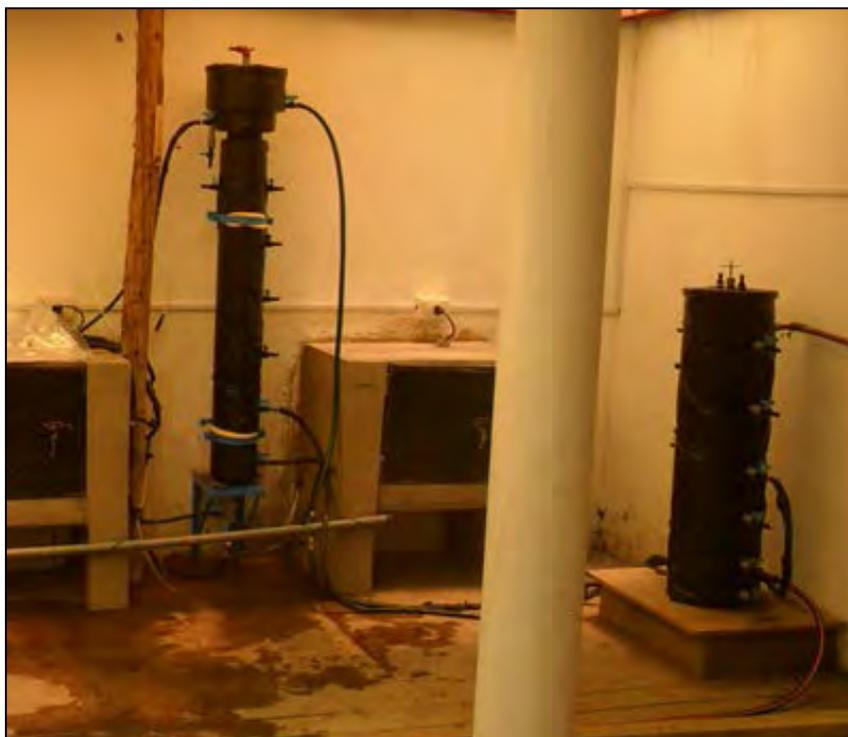
Fotografía N° 5.26: El reactor UASB y digester se cubrió con plástico negro al igual que circuitos de manguera
