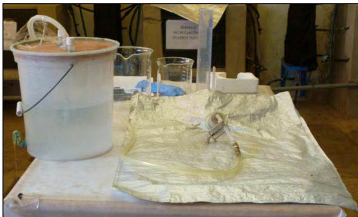
**Fotografía N° 5.21: Materiales para medir gas metano**
