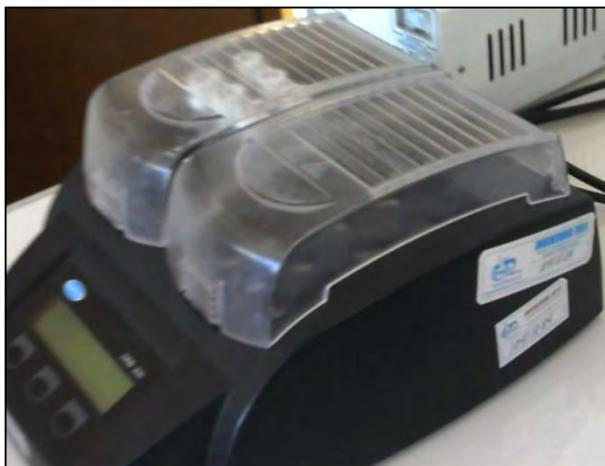
**Fotografía N° 5.19: Digestor modelo DBR 200, para la DQO**
