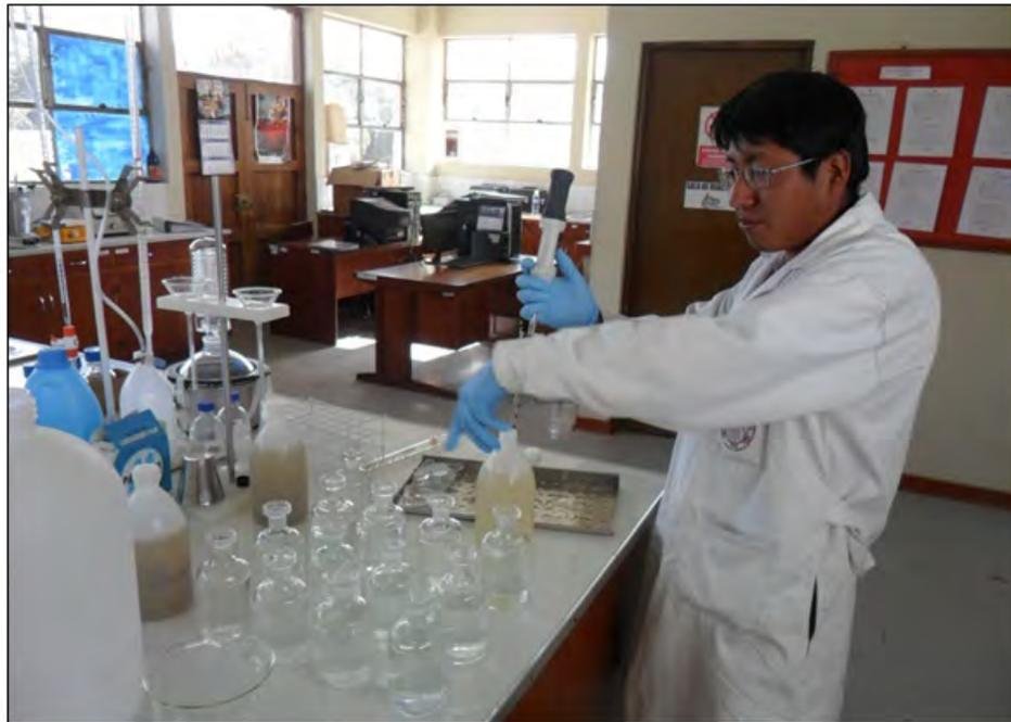
**Fotografía N° 11.6: Prueba de la DBO<sub>5</sub>**
