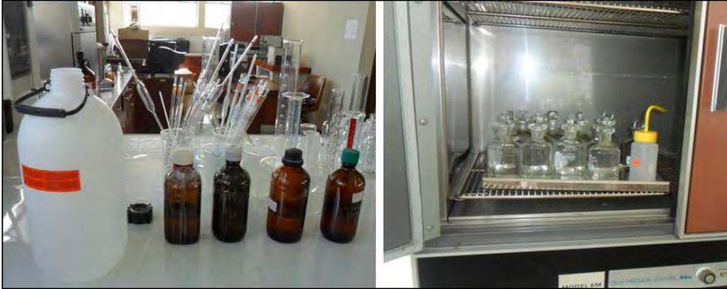
**Fotografía N° 5.18: Agua de dilución y nutrientes (izquierda), Incubadora con frascos esmerilados (derecha)**
