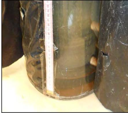
**Fotografía N° 5.31: Acumulación de óxido en la base del digestor de lodos**
