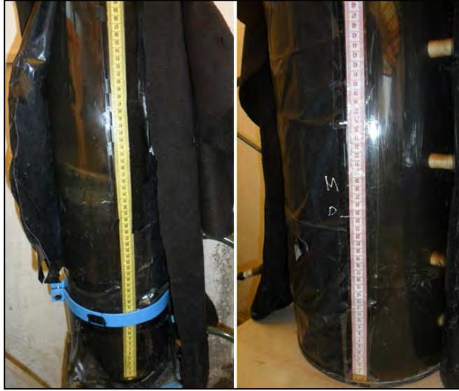
**Fotografía N° 5.22: Cinta métrica para reactor UASB (izquierda), y para digester (derecha)**
