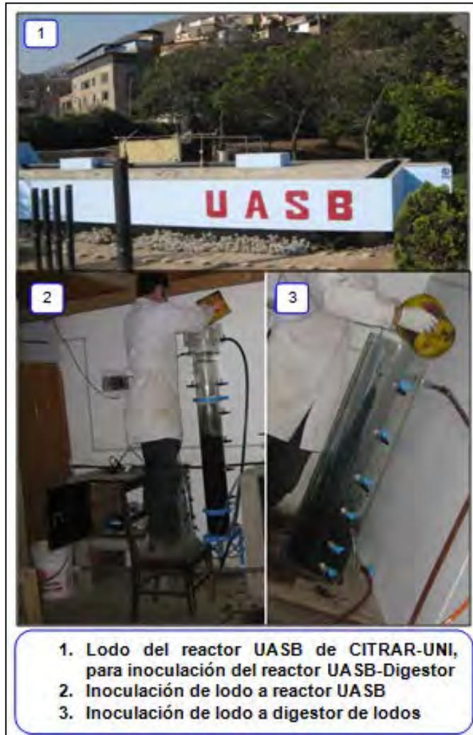
Fotografía N° 5.25: Inoculación de lodo en reactor UASB y digestor de lodos
