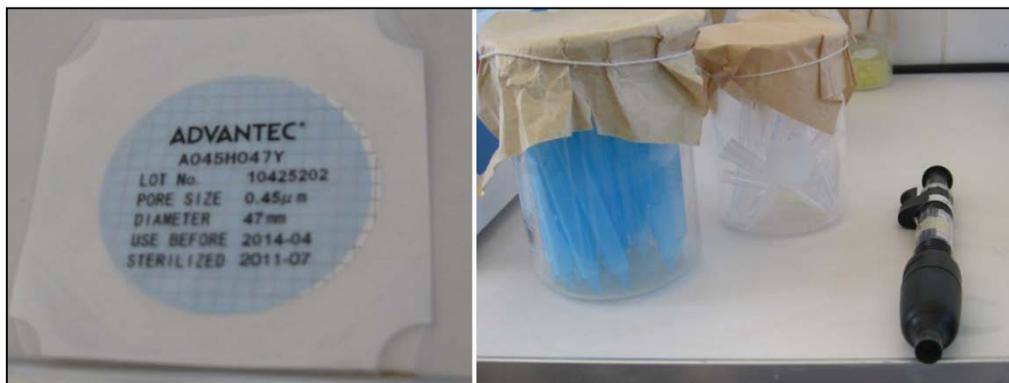
**Fotografía N° 5.20: Filtración de 0.45µm para DQO Soluble (Izquierda), Puntas de pipeta y propipeta (Derecha)**
