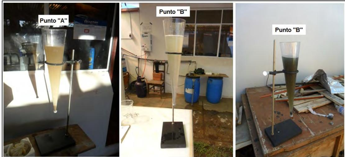
**Fotografía N° 11.11: Sólidos sedimentables, izquierda (entrada de agua residual), medio (Salida de UASB TRH 12 horas), derecha (Salida UASB TRH 4 horas)**
