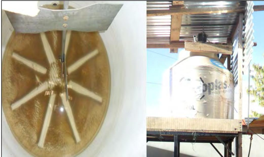
**Fotografía N° 5.24: El mezclador mecánico después de su reparación (izquierda) y el piezómetro colocado al tanque (derecha)**
