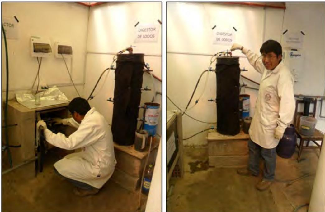
Fotografía N° 11.2: Programación de bomba peristáltica (izquierda), agitación de mezclador mecánico en digestor.
