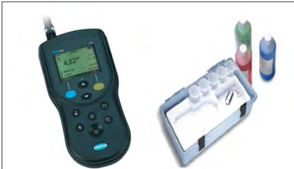
**Fotografía N° 5.12: pH Digital Hach HQ11D , Soluciones Buffer**
