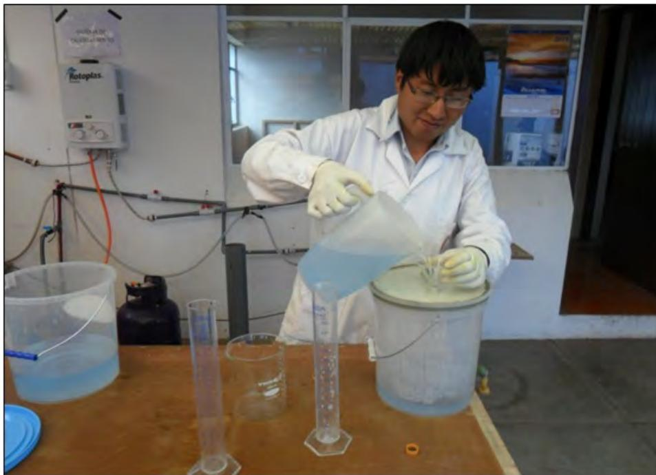
**Fotografía N° 11.8: Solución de hidróxido de sodio, para medir el metano**
