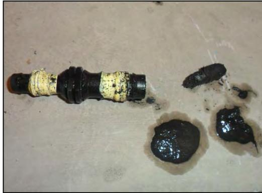
**Fotografía N° 5.27: Accesorio atorado con lodo del digestor**
