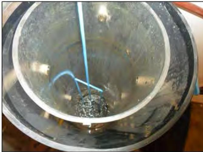
**Fotografía N° 5.29: Deficiente traslado de lodo del digester ocasiona la pérdida del nivel constante de lodo**
