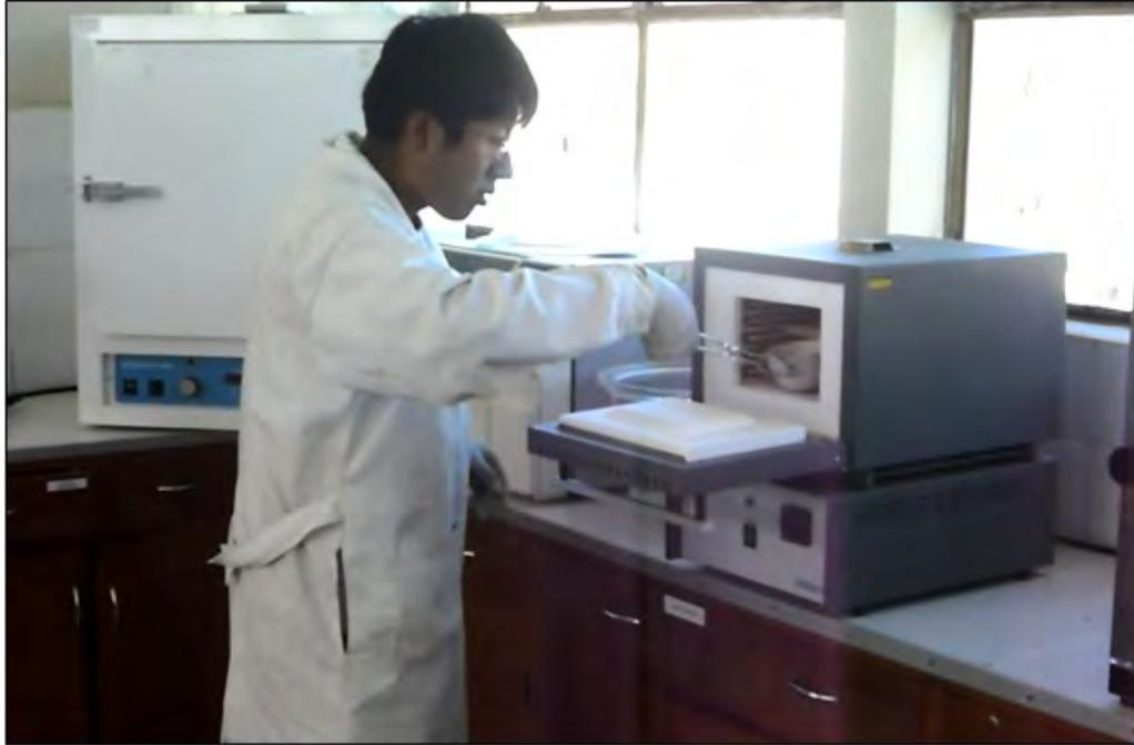
**Fotografía N° 11.7: Determinación de sólidos volátiles totales y sólidos suspendidos volátiles.**
