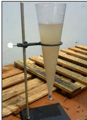
**Fotografía N° 5.17: Medición de sólidos sedimentables en cono Imhoff**
