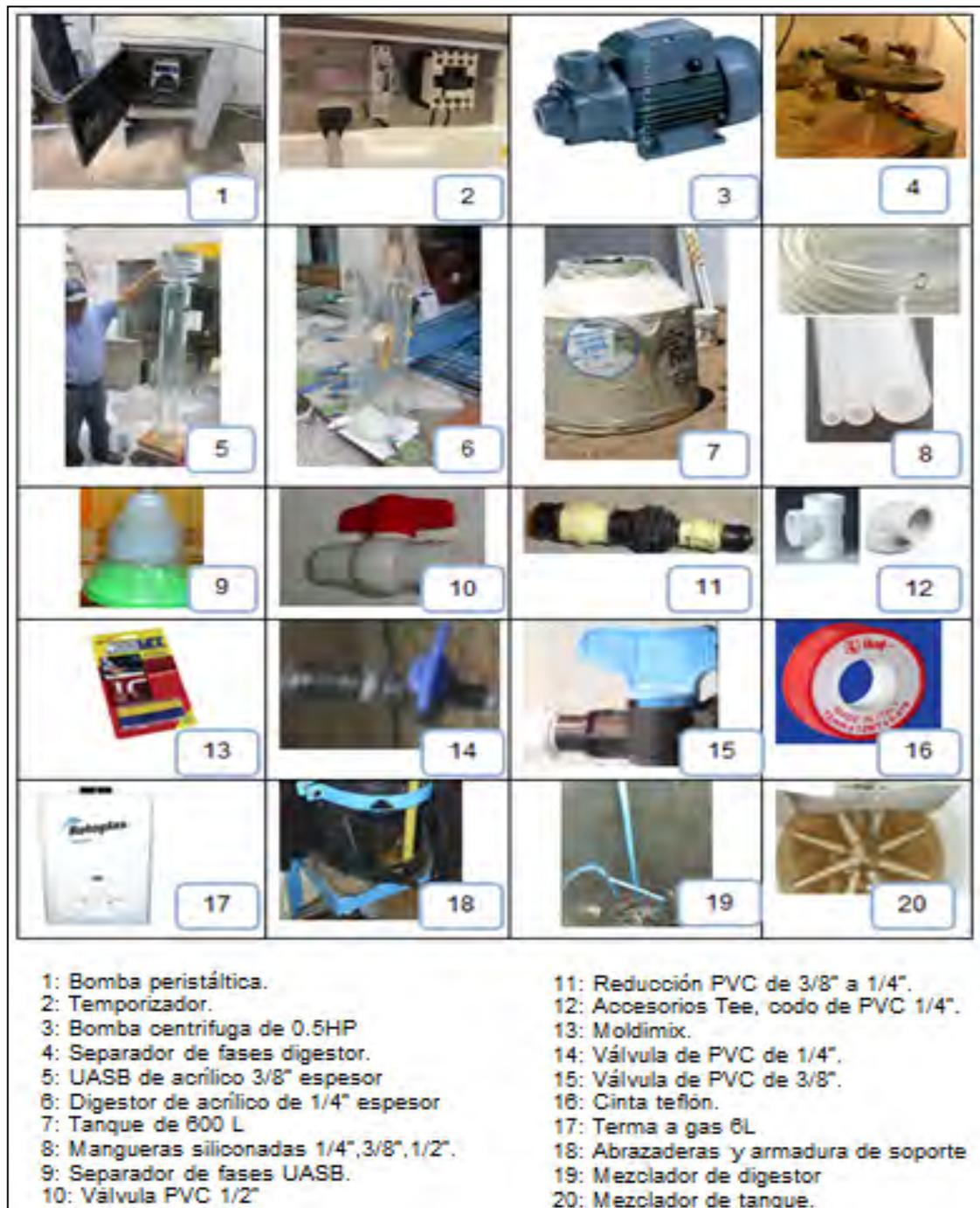
Figura N° 5.3: Materiales usados para instalar el reactor UASB-Digestor
