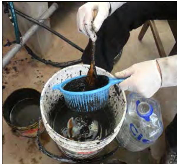
**Fotografía N° 5.28: Filtración del lodo usando un colador de cocina y espátula**
