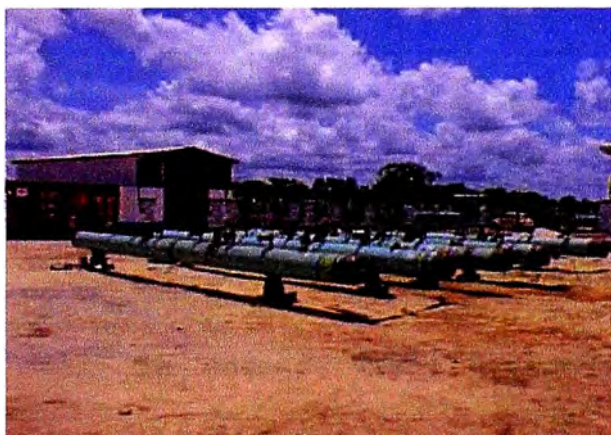
a) Cabezales para prueba hidrostática
