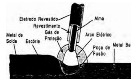
Figura 8 Diagrama esquemático da soldagem com eletrodos revestidos.
