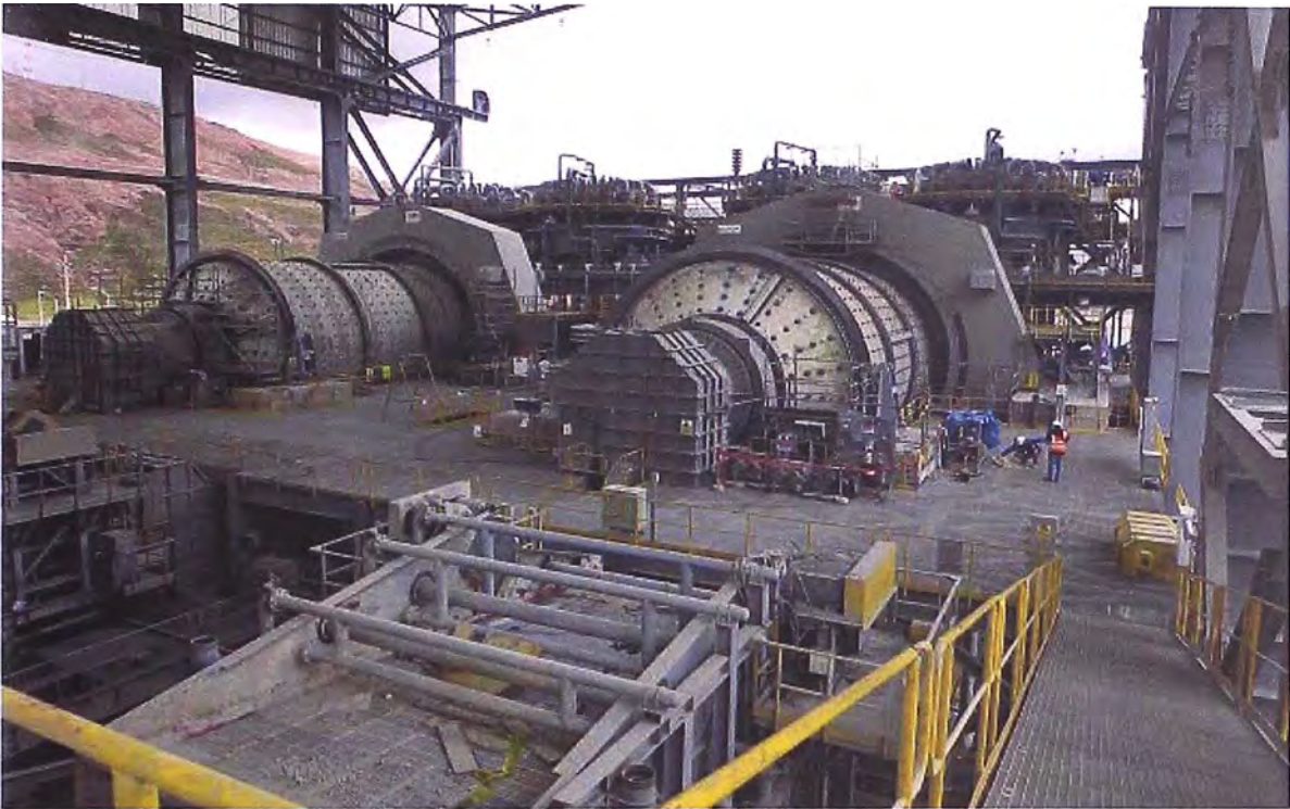
Foto 5.23.- Se muestra los 2 Molinos de Bolas en operación. Ver en parte posterior los 4 nidos de ciclones que los alimentan.
