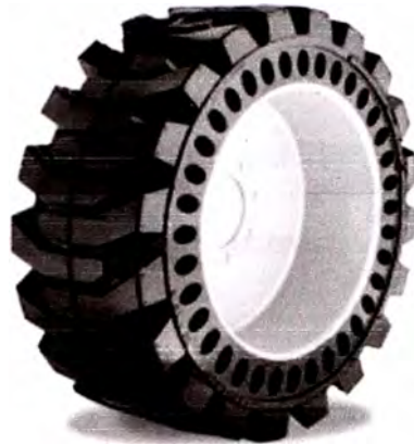
Figura N° 1.11 Rueda (llanta) de un cargador Frontal
