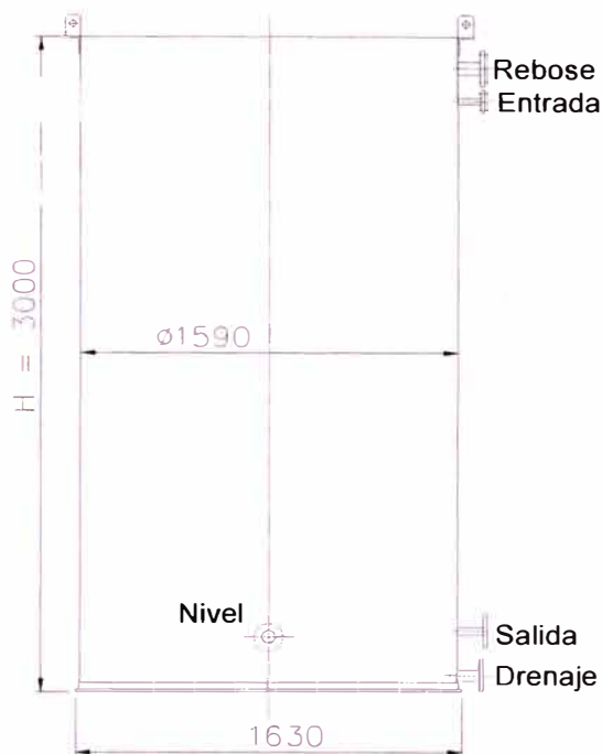
Figura N° 4.7 – Tanque de soda cáustica recuperada
