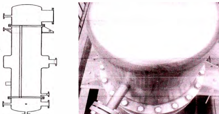
Figura N° 4.14 – Evaporador fijado a la estructura con pernos
