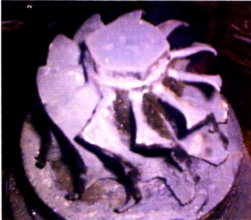
Fig. 6.6: Alabes de turbina de turbocompresor (lado derecho) con presencia de impacto por partículas que se desprendieron de las coronas de los pistones fallados por alta temperatura
