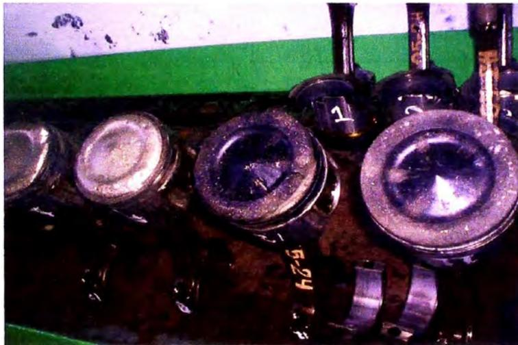
Fig. 6.9: Cabezas de pistón presentan incrustaciones de partículas provenientes de los pistones que fallaron a través del sistema de admisión
