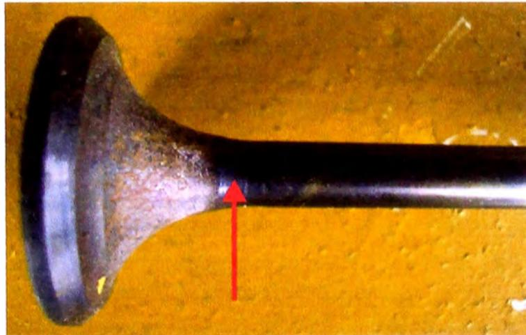
Fig. 6.16: Presencia de coloración en el vástago de la válvula de escape del cilindro 8
