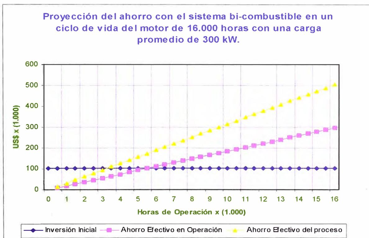
Fig. 5.5: Proyección del ahorro con el sistema bi-combustible en un ciclo de vida del motor
