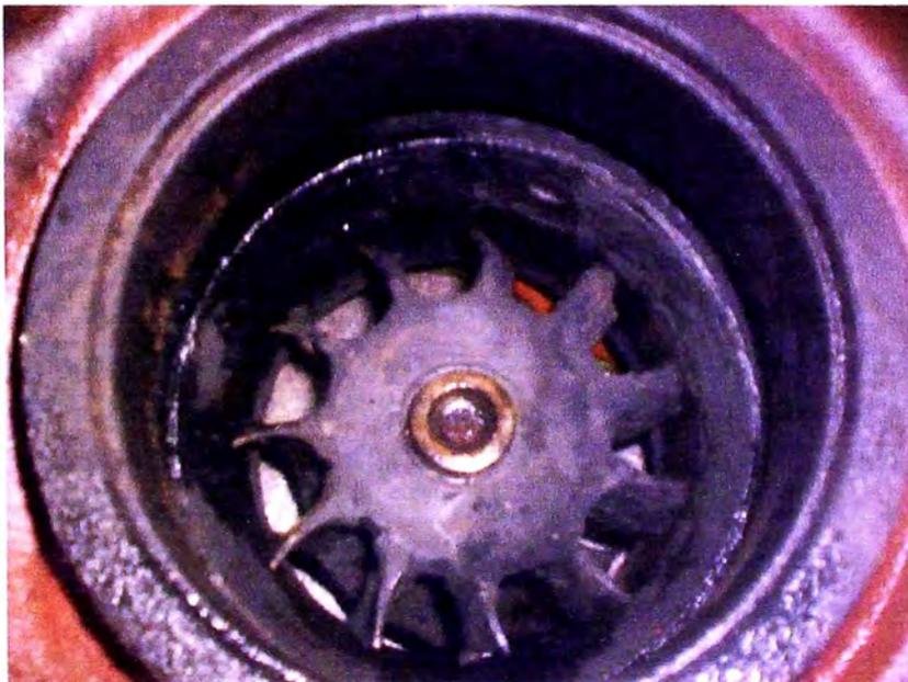
Fig. 6.7: Presencia de aceite en el caracol de la turbina de compresor (lado derecho) debido a fractura de eje motriz
