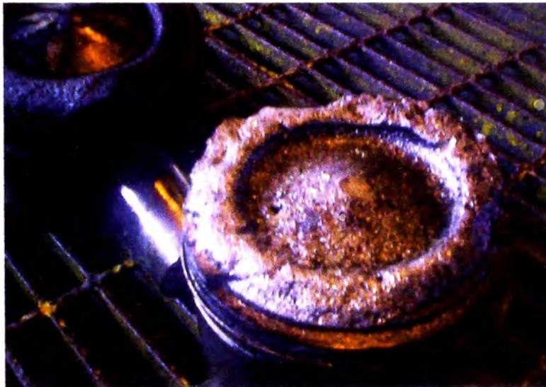
Fig. 6.2: Corona de pistón de cilindro 08, presenta fundición por alta temperatura en la cámara de combustión
