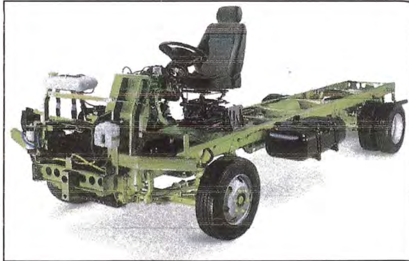
Figura 4.3 – Chasis Agrale MA 8.5-EURO II D.E.E 4200 con motor Cummin's B5.9.
