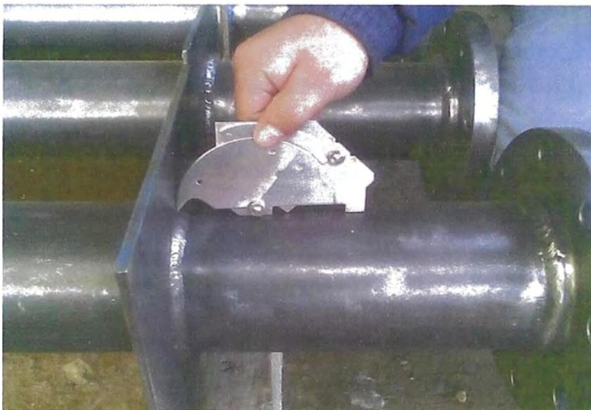
**Figura 3.9 Inspección a Juntas soldadas – Filte.**
