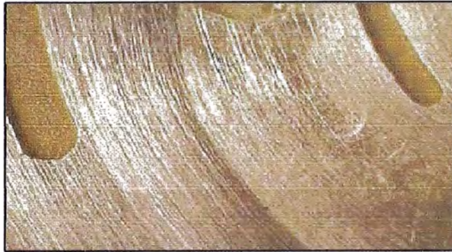
Figura IV.35 Superficie con Ralladuras, aceite contaminado
