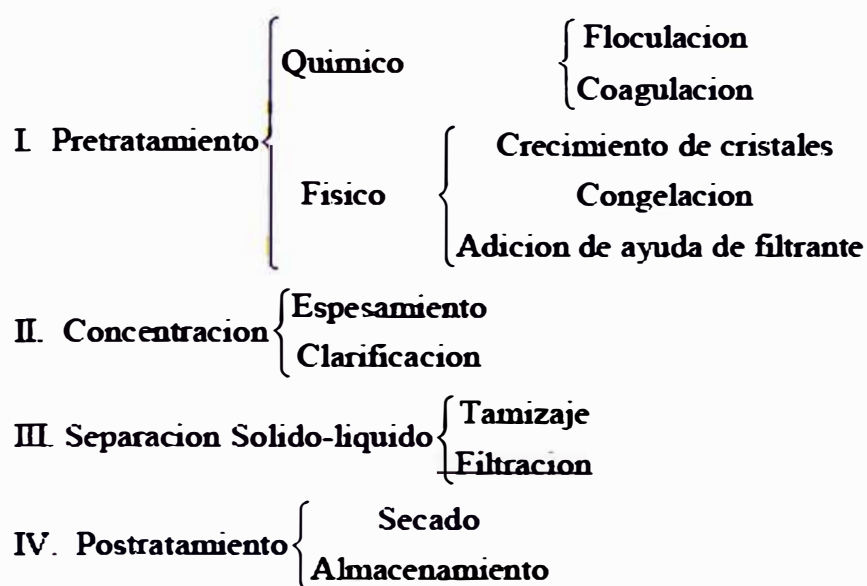
Fig. 2.2 Esquema de los procesos de separación sólido-líquido
