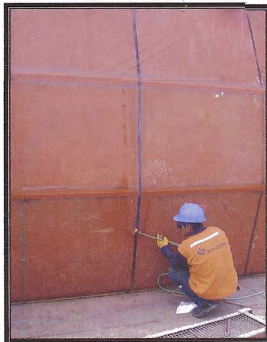
Figura 4.16, Enderezado por calentamiento con soplete.
