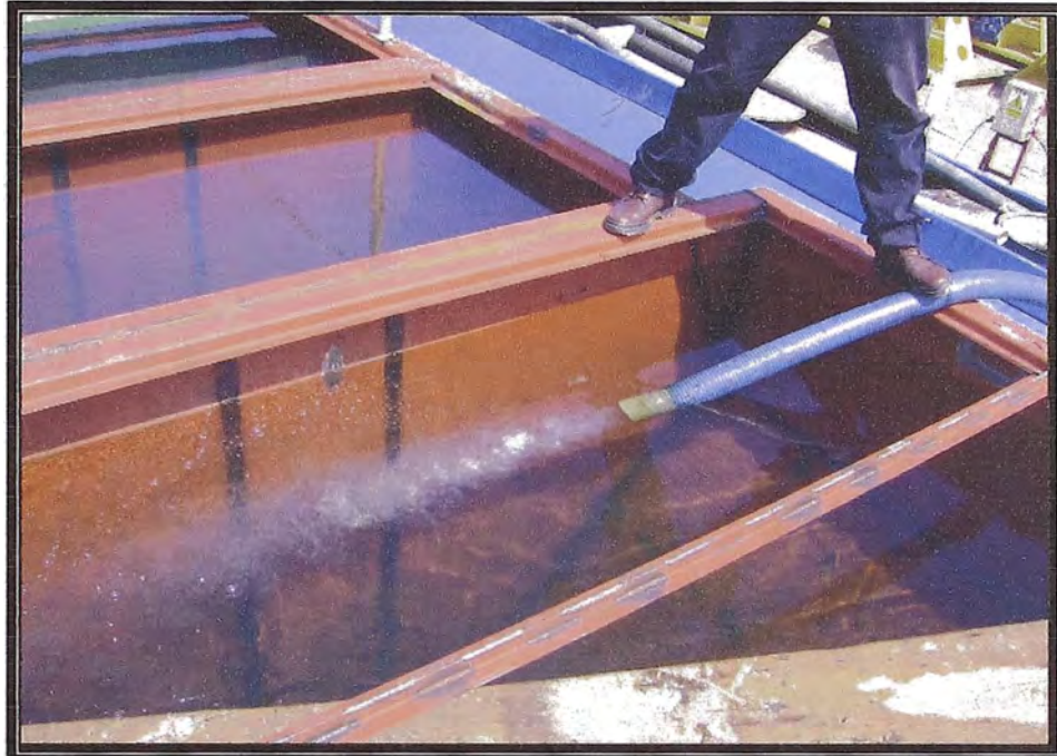
Figura 4.27, Nivel de agua 4” antes del nivel superior.
