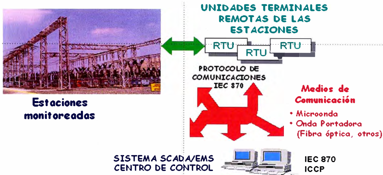
Figura 3–1 Sistema de Supervisión de un Sistema Eléctrico
