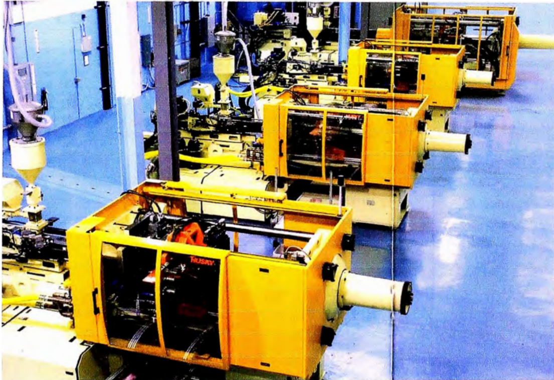
Figura 3.1. Fotografía de una Planta de Inyección típica.
