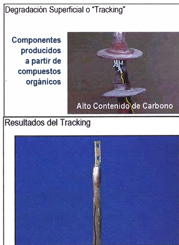
Figura 3.11 Efectos del tracking en terminaciones de alto contenido de Carbono.
